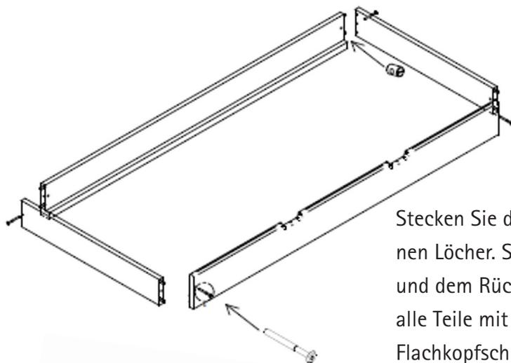
Stecken Sie die 8 mm Holzdübel in die vorgesehenen Löcher. Setzen Sie die Seitenteile mit der Front und dem Rücken zusammen und verschrauben alle Teile mit Hilfe der Quermutterbolzen und der Flachkopfschrauben.
