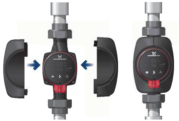
Abb. 8 Dämmen des Pumpengehäuses
