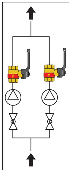
Der Kugelhahn, in den das Rückschlagventil integriert ist, hat dagegen Absperrfunktion: bei einem Ausbau der Pumpe oder einer Kesselentleerung braucht nicht das ganze Leitungssystem entleert zu werden.
