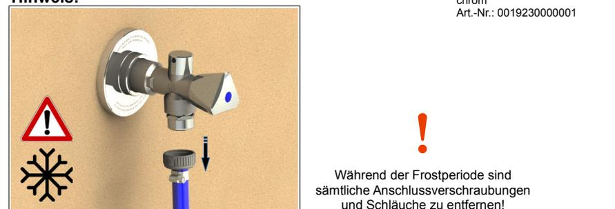
**Achtung!** Bevor Sie mit der Fertigmontage beginnen, ist das Rohrsystem druckfrei zu machen. Nach Montage der Armatur ist eine Druck- und Funktionsprüfung durchzuführen!
