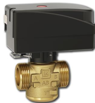
LK 525 MultiZone ist ein motorisiertes 2-Wege Zonenventil für Heizsysteme, in denen der Volumenstrom durch eine oder mehrere Zonen gesteuert werden soll. Das Zonenventil ist für die Ein-/Aus-Regelung und verfügt über einen Drehschieber, weshalb es einen höheren Differenzdruck aushält und die Gefahr verringert, dass es bei einer längeren Betriebsunterbrechung hängen bleibt. Auf der Oberseite des Motors befindet sich eine Anzeige, die angibt, welcher Ventilanschluss geöffnet oder geschlossen ist.
