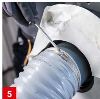
5 Flexiblen Universalschlauch<sup>2</sup> mit einer Schlauchschelle am Anschlussstutzen der Lüfterpfanne befestigen.
