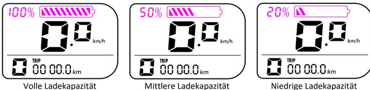
Die Ladekapazität des Akkus wird im Display sowohl über das Batteriesymbol als auch über eine prozentuale Zahlenangabe angezeigt.
