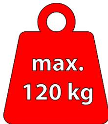
Ihr Fahrrad ist für eine Gesamtnutzlast von 120kg ausgelegt. Die Gesamtnutzlast beinhaltet das Leergewicht des Fahrrads inkl. Akku (diese beträgt 20,6kg), Die Fahrerin oder den Fahrer und ein zusätzliches Gepäck. Überschreiten Sie die zulässige Gesamtnutzlast nicht. Dies kann Schäden an mechanischen Komponenten, wie Rahmen oder Federgabel, führen und stellt ein erhebliches Sicherheitsrisiko dar!
