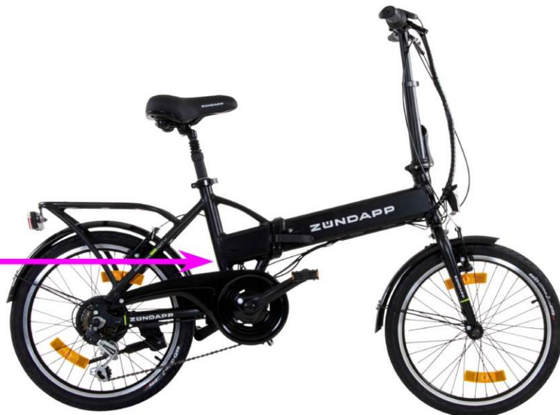
Das Typenschild ist an der Hinterseite des Sattelrohrs angebracht. Diese Position gilt für die folgenden Modelle:
