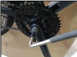
Demontieren Sie die Kurbel. Hierfür benötigen Sie einen Kurbelabzieher für ein Vierkanttretlager.
