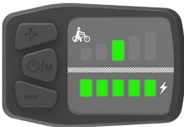
Die blinkenden LED 4 und 5 zeigen einen Fehler auf der vom Steuergerät nicht kategorisiert werden kann. Hier kann nur im Ausschlussverfahren festgestellt werden welches Bauteil für den Fehler verantwortlich ist.
