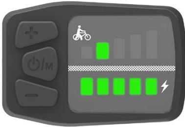
Die blinkende LED 2 zeigt einen Überstromfehler der Phasenverteilung am Steuergerät auf. Gehen Sie wie folgt vor, um den Fehler-Code beheben:
