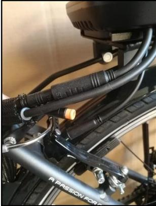
Lösen Sie die Steckverbindung des Tretlagersensors (orangener Stecker) und ziehen Sie das Kabel nach unten komplett heraus.
