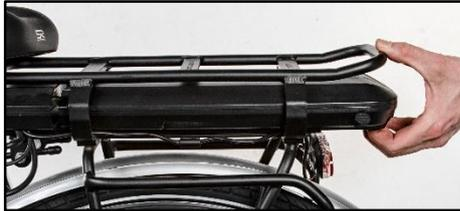
Schalten Sie Ihr System ab und entnehmen Sie den Akku aus der Akkuhalterung.
