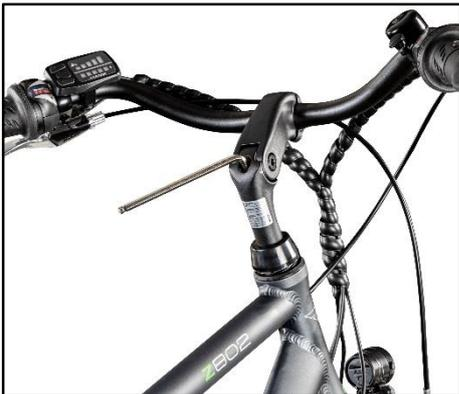
Stellen Sie anschließend den Lenker gerade. Über die zentrale Spanschraube im Vorbau ist die Höhe zu einem gewissen Grad einstellbar.
