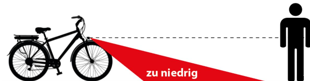
Stellen Sie Ihr Vorderlicht so ein, dass die Strecke vor Ihnen genügend ausgeleuchtet wird und, dass der entgegenkommende Verkehr nicht geblendet wird.
