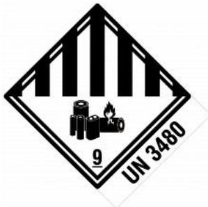
Für den Versand muss der Versandkarton mit dem entsprechenden Gefahrengutsymbol, UN3480 / Gefährdungsklasse 9, versehen sein. Dieses Gefahrengutsymbol muss deutlich, klar erkennbar und unbeschädigt auf dem Versandkarton angebracht sein.
