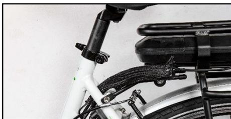
Stecken Sie alle Steckverbindungen zusammen und schieben Sie die Kabelschutzhülle nach oben. Das obere Ende der Kabelschutzhülle sollte mit einem Kabelband fixiert werden.
