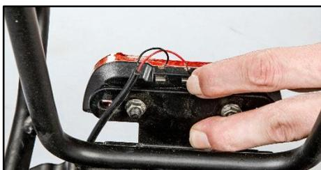
Drücken Sie die Kabelklemme um das Lichtkabel herauszuziehen. Merken Sie sich welche Farbe des Lichtkabels in welche Klemme gehört.
