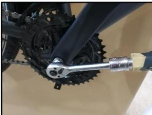
Demontieren Sie die Kurbelanzugschraube. Hierfür eignet sich am besten eine 14 mm Sechskantnuss.
