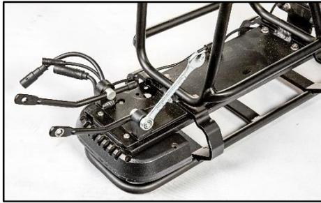
Demontieren Sie die zwei Montagestreben.
