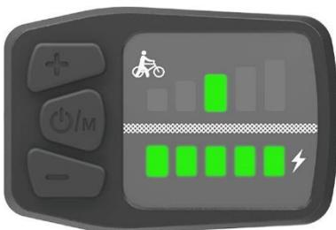
Die blinkende LED 5 zeigt einen Fehler auf der vom Steuergerät nicht kategorisiert werden kann. Hier kann nur im Ausschlussverfahren festgestellt werden welches Bauteil für den Fehler verantwortlich ist.
