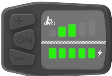
Die blinkenden LED 2 und 3 zeigen eine Fehlinformation vom Tretlagersensor zum Steuergerät auf. Gehen Sie wie folgt vor, um den Fehler-Code beheben:
