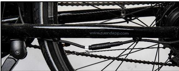
Die Steckverbindung für den Motorstecker finden auf der linken Seite (Blick in Fahrtrichtung) Ihres Fahrrads. Ziehen Sie die Steckverbindungen auseinander und prüfen Sie, ob keiner der Pins beschädigt oder verbogen ist und ob die Steckverbindungen trocken und schmutzfrei sind. Anschließend stecken Sie die Verbindungen wieder zusammen.
