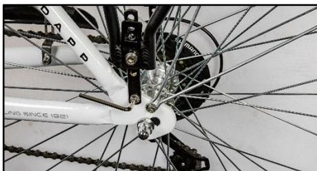
Demontieren Sie die beiden Schrauben mit denen der Gepäckträger an den hinteren Ausfallenden montiert ist und heben Sie den gesamten Gepäckträger vom Fahrrad herunter.
