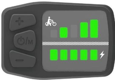
Die blinkenden LED 2,4 und 5 zeigt einen defekten MCU (main control unit) des Displays an.
