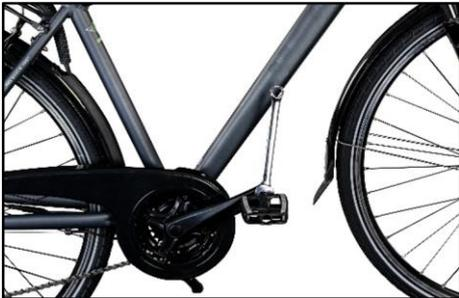
Montieren Sie die Pedale. Achten Sie dabei auf die Markierungen „L“ und „R“ auf den Pedalen. Das mit „R“ gekennzeichnete Pedal wird auf der rechten und das mit „L“ gekennzeichnete auf der linken Seite (Blick in Fahrtrichtung) des Fahrrads montiert. Dabei wird das linke Pedal entgegen des Uhrzeigersinns und das rechte Pedal im Uhrzeigersinn eingedreht.
