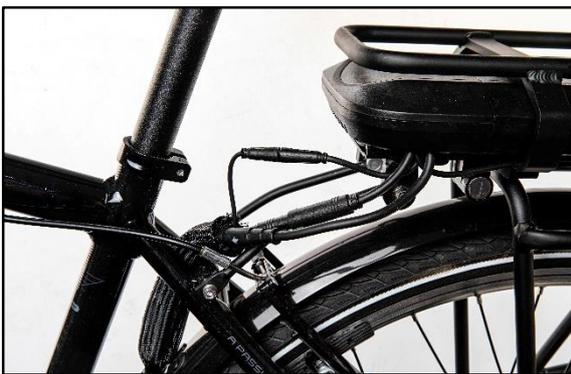
Die Steckverbindungen direkt am Steuergerät finden Sie unter der Gewebehülle am vorderen Ende des Gepäckträgers. Dafür müssen Sie die Hülle etwas nach unten schieben bis Sie die Steckverbindungen sehen. Ziehen Sie die Steckverbindungen auseinander und prüfen Sie, ob keiner der Pins beschädigt oder verbogen ist und ob die Steckverbindungen trocken und schmutzfrei sind. Anschließend stecken Sie die Verbindungen wieder zusammen und schieben die Gewebehülle zurück.
