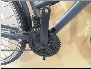
Demontieren Sie den Kettenschutz. Hierfür benötigen Sie einen gängigen Kreuzschraubendreher und einen 3 mm Innensechskantschlüssel.
