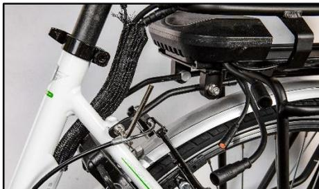
Demontieren Sie die beiden Schrauben an den Montagestreben des Gepäckträgers.
