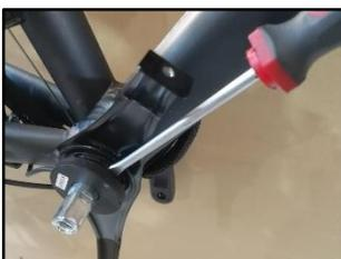
Durch leichtes Aushebeln mit, einem gängigen Schlitzschraubendreher, demontieren Sie den Sensor von der Tretlagerachse. Hebeln Sie dabei behutsam und ringsum am Sensor bis Sie diesen mit der Hand von der Tretlagerachse ziehen können.
