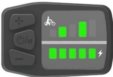
Die blinkenden LED 2 und 4 zeigen eine stark Erhöhte Temperatur des Steuergeräts an.
