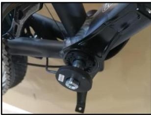
Schieben Sie den neuen Tretlagersensor von Hand komplett auf die Tretlagerachse. Achten Sie dabei darauf, dass das abgehende Kabel am Sensor in etwa die selbe Position aufweist wie es zuvor beim alten Sensor der Fall war.
