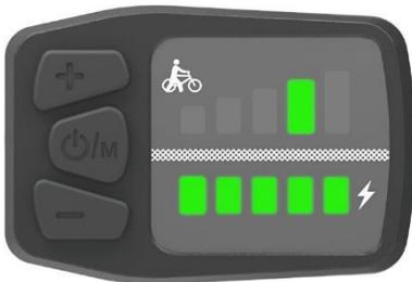
Die blinkende LED 4 zeigt eine Fehlfunktion mit einer oder beiden der Bremshebeln auf.
