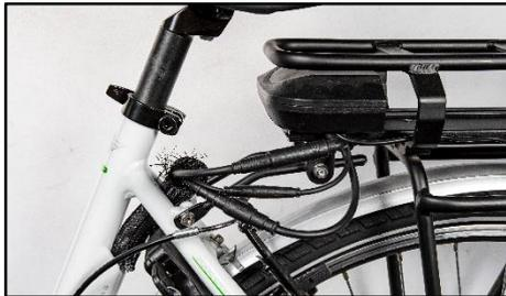
Ziehen Sie die Kabelschutzhülle nach unten und ziehen Sie alle Steckverbindungen auseinander.
