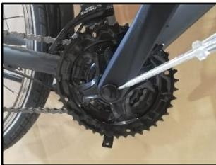
Entfernen Sie, durch leichtes Aushebeln, die Abdeckkappe der Kurbelanzugschraube. Hierfür benötigen sie einen gängigen Schlitzschraubendreher.
