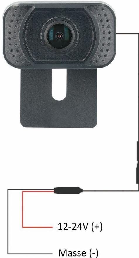
**a.** Die Kamera ist grundsätzlich durch das Einschalten bzw. das bereitstellen von 12 V Spannungsversorgung direkt Betriebsbereit. Sie kalibriert sich eigenständig mit dem Monitor und stellt sofort ein Bildsignal zur Verfügung. Extraeinstellungen müssen hierfür nicht durchgeführt werden.
