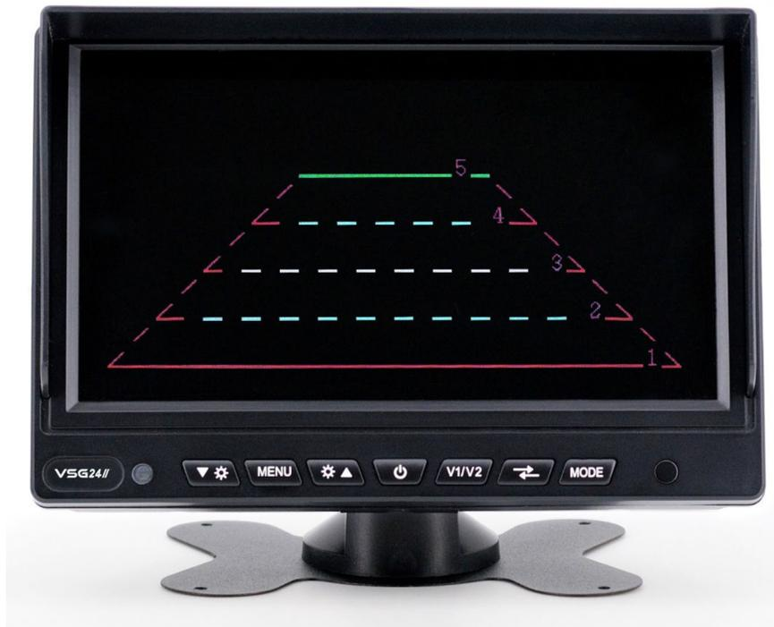
Drücken Sie die **TASTE 2 (MENU)** mehrfach bis im Display PARK2 erscheint, um die Distanzlinien-Anzeige einzuschalten. Hier können Sie nun mit der **TASTE 1** oder **TASTE 3** zwischen ON bzw. OFF wählen. Wenn Sie die Funktion mit ON bestätigt haben, werden die Distanzlinien automatisch auf dem Kameraeingang 2 eingeblendet.
