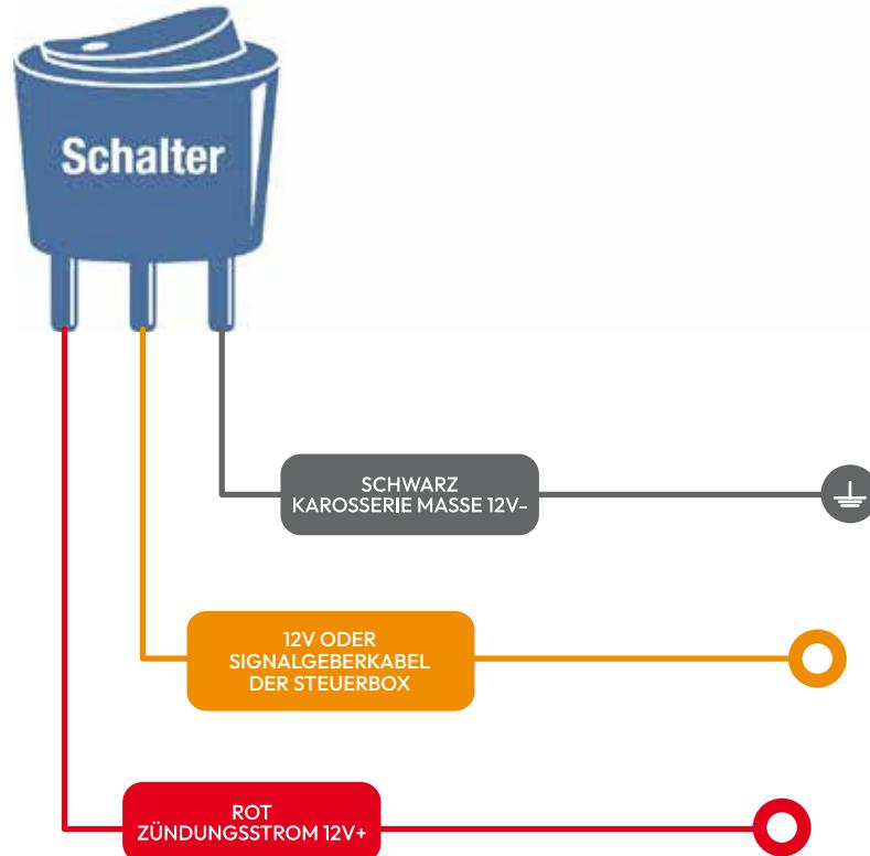
Mit diesem Schalter kann die Einparkhilfe manuell aktiviert werden. Dadurch können Sie den Betrieb der Einparkhilfe flexibel nach Ihren Bedürfnissen ein- und ausschalten.
