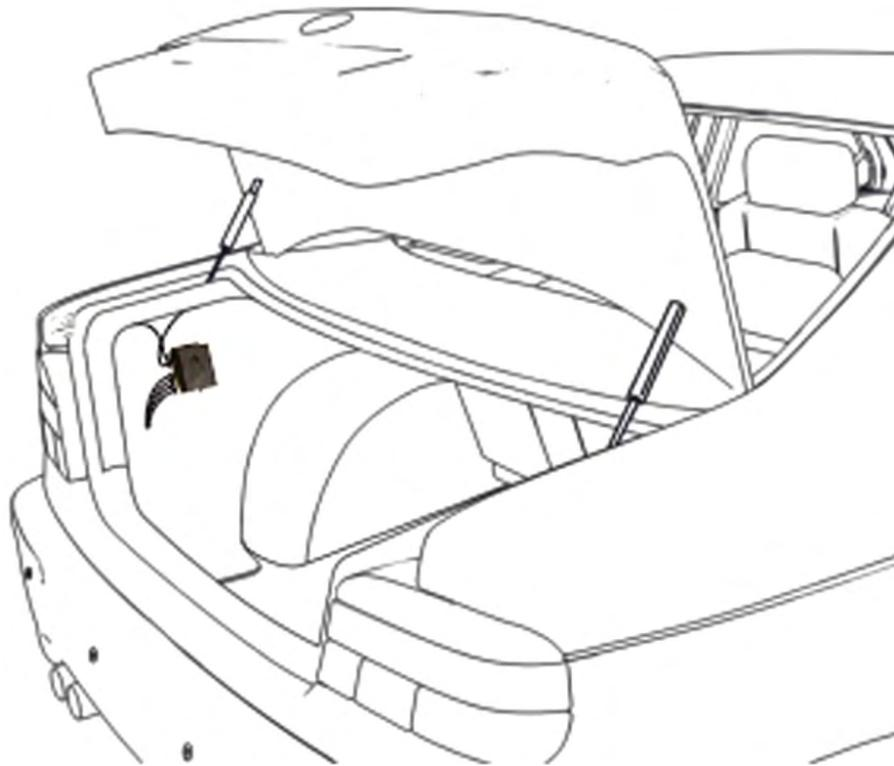
Die Steuereinheit muss im Inneren des Fahrzeuges verbaut werden. Idealerweise bietet sich hierfür der Kofferraum an. Die Nähe einer Rückfahrleuchte ist dabei von Vorteil, denn Sie müssen von dieser die Stromspannung abgreifen. Führen Sie danach alle Leitungen der Sensoren nach innen. Gehen Sie dabei sicher, dass keine Feuchtigkeit ins Wageninnere gelangen kann. Achten Sie beim Verlegen, dass Sie keine Kabel oder andere Leitungen bzw. Materialien beschädigen.
