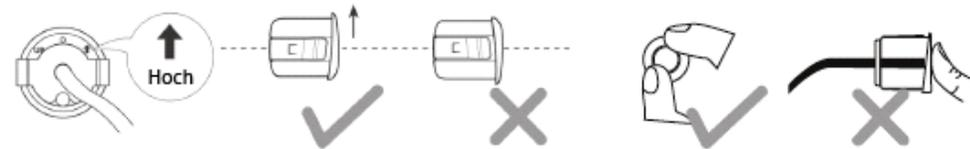
Die Sensoren sind mit einem Pfeil auf der Rückseite oder den Buchstaben „UP“ gekennzeichnet. Dieser markiert die Oberseite des Sensors. Dieser Teil muss also beim Einbau nach Oben zeigen. Beim Einsetzen drücken Sie bitte nur auf die Außenränder des Sensors. Drücken Sie keinesfalls in den Mittelteil. Dort liegen empfindliche Messteile. Diese können bei Druck zerstört werden.
