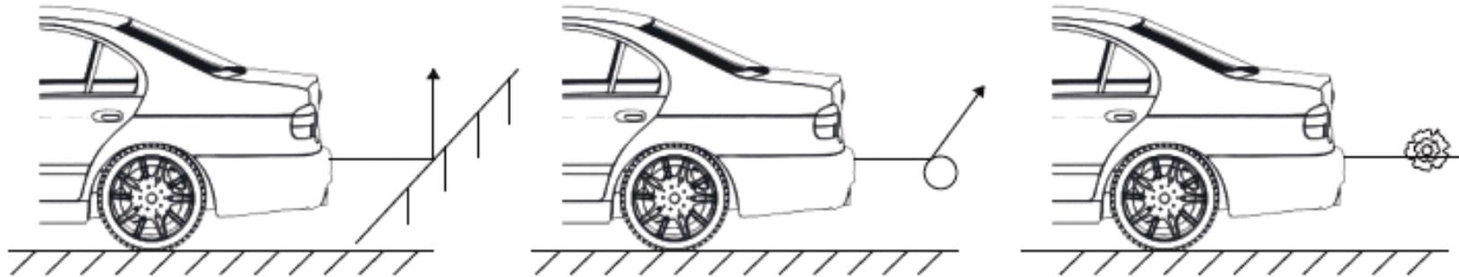
Die oberen Abbildungen stellen dar, wann keine zuverlässige Sensorerfassung erfolgen kann. In diesen Fällen lassen Sie sich bitte nicht durch die Anzeige oder den Ton irritieren. Sie müssen dann nach Ihrem eigenen Ermessen den Abstand abwägen. Die Anlage darf in diesen Fällen nicht zur Hilfe genommen werden. Dies gilt, wenn der Hintergrund schräg nach oben oder unten abläuft, wenn runde Körper zu erfassen sind oder Körper mit anderen als geraden Abstrahlwinkel.
