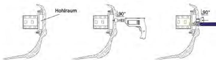
Gehen Sie bitte sicher, dass sich hinter der geplanten Bohrstelle ein Hohlraum befindet. Es dürfen keine Karosserieteile, Kabel oder ähnliches dort verlaufen. Der Bohrwinkel zur Stoßstange muss exakt im 90° Winkel erfolgen.
