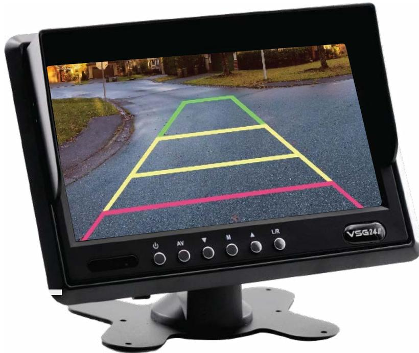
Drücken Sie die **TASTE 4 (MENU)** 2 x um die Distanzlinien Anzeige einzuschalten. Hier können Sie nun mit der **TASTE 3** oder **TASTE 5** zwischen EIN bzw. AUS wählen. Wenn Sie die Funktion mit EIN bestätigt haben, werden die Distanzlinien auf dem aktivierten Kameraeingang eingeblendet, sobald das grüne oder blaue Triggerkabel angeschlossen ist.
