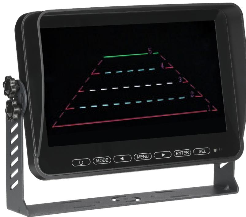
Drücken Sie die **TASTE 4 (MENU)** und anschließend **7 x** die **TASTE 6 (ENTER)** um die Funktion DISTANZLINIEN aufzurufen. Bestätigen Sie ihre Auswahl mit der **TASTE 5**. In diesem haben Sie die Möglichkeit die Distanzlinien pro Kameraeingang zu zuschalten.
