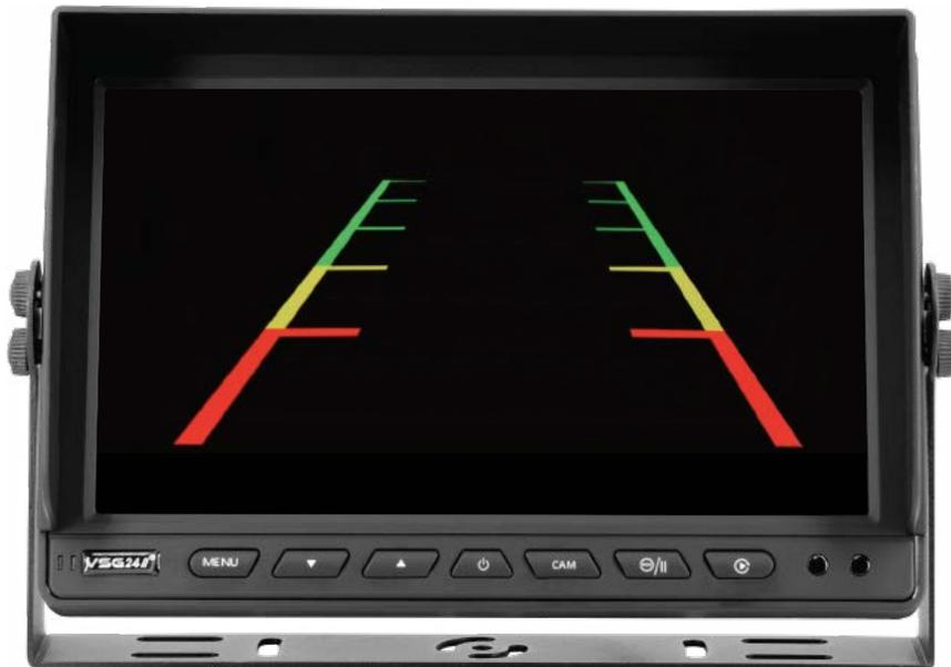
Drücken Sie die **TASTE 1 (MENU)** und anschließend **3 x** die **TASTE 7 (PLAY)** um in das Funktionen Menü zu gelangen. In diesem haben Sie die Möglichkeit die Distanzlinien zu zuschalten. Um in das Funktionen-
