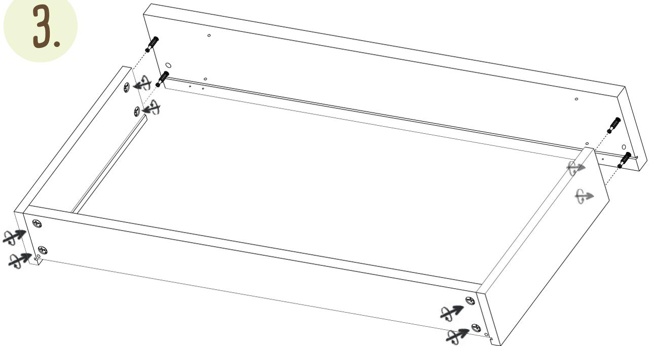
EXZENTER-BESCHLÄGE MIT DEM KLEINEN DREIECK IN RICHTUNG DER SPÄTEREN SCHRAUBE PLATZIEREN UND FESTZIEHEN.
