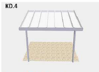
Terrassenüberdachung mit eingerückten Stützen.
