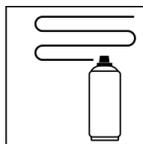
2 - 3 dünne Schichten im Kreuzgang aufsprühen, erst vertikal dann horizontal: ca. 40 - 50 µm
