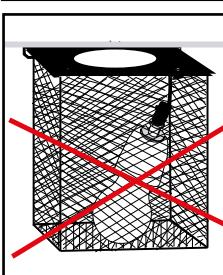
Należy pamiętać, że oprawy oświetleniowe nie mogą być po prostu układać w klatce ochronnej, ale muszą być dodatkowo zabezpieczone przed upadkiem - ryzyko pożaru! W celu zachowania minimalnych odległości od zastosowanych lamp należy przestrzegać instrukcji bezpieczeństwa producenta.
