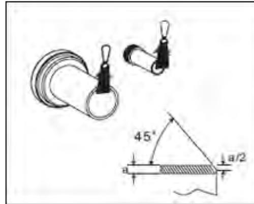
Schrägen Sie das Rohr mit einer Feile um 45° ab an der Auslassseite
