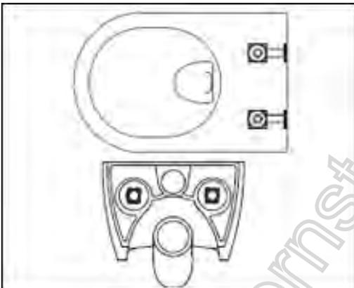
Drehen Sie die Montage Hülsen im Wc mit der Öffnung nach oben, so dass die Sechskantschraube von oben fixiert werden kann.
