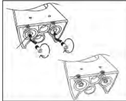
Setzen Sie die Hülsen auf die Vorrichtung in der Toilette für die Haltestangen
