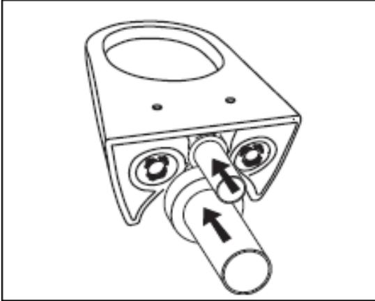
Montieren Sie die Rohre an der Toilette
