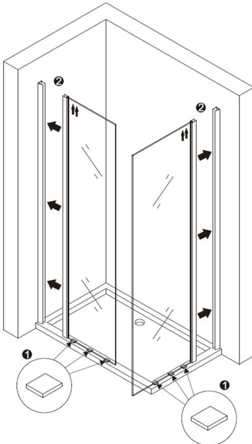
Fixieren Sie die „L“ Halteschiene mit den Schrauben wie auf dem Bild zu sehen
