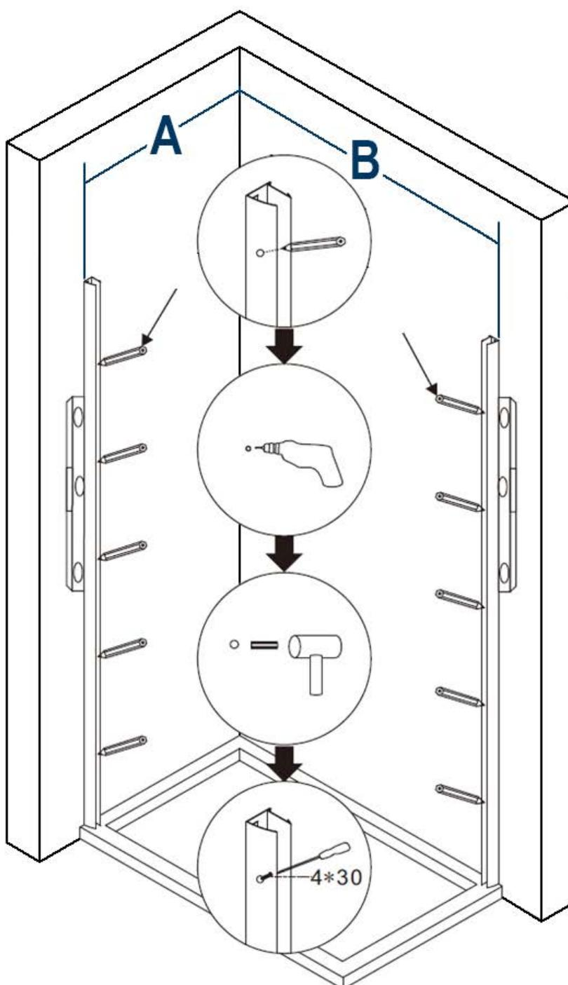
1. Setzen Sie die kleinen Gummilippen unter das feste Glaselement (wie unten auf der Abbildung 1). Diese verhindern das Aufkommen von Spannungen im Glas. Die Überstände werden nach der Montage entfernt.
