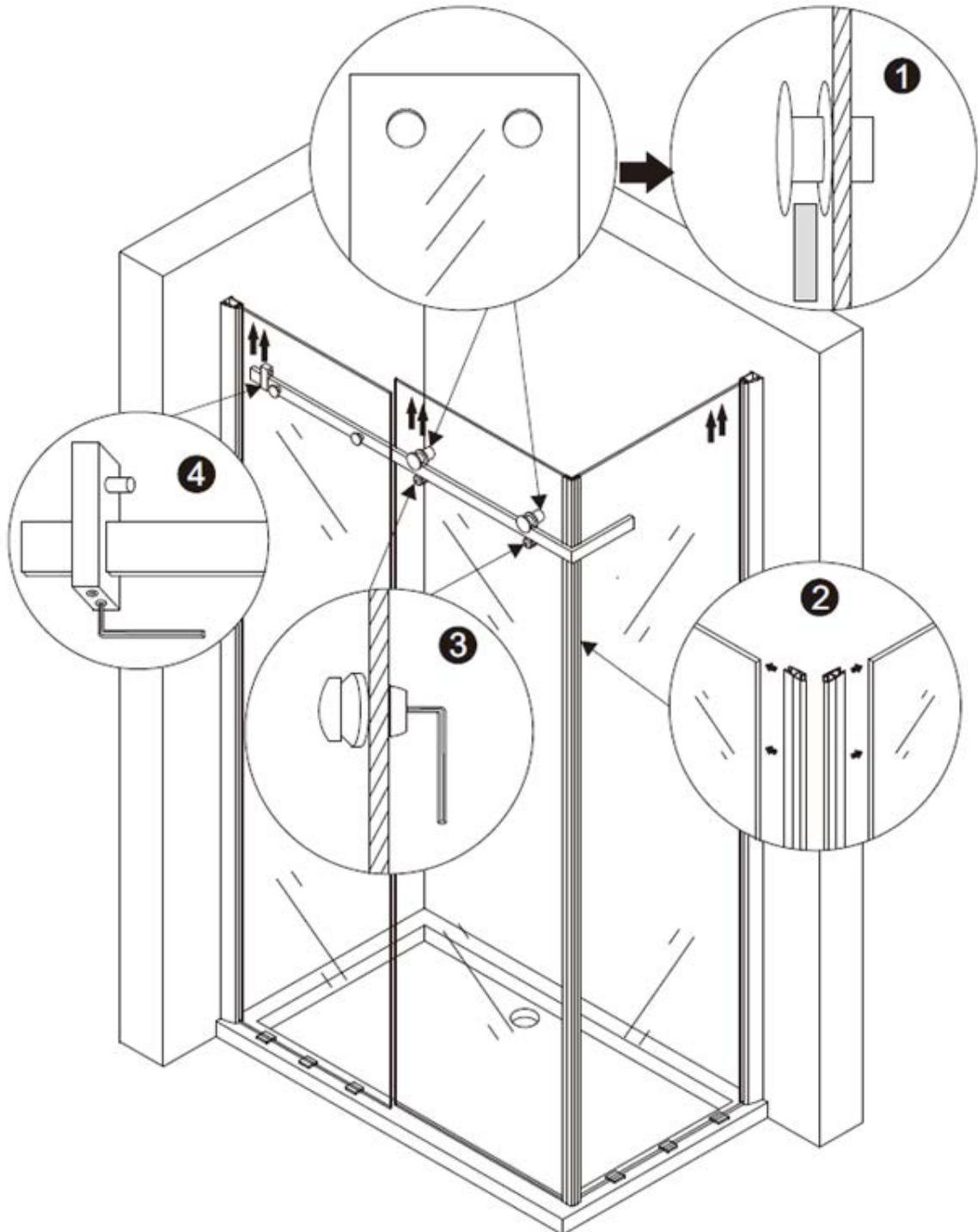
1. Fixieren Sie mit Silikon die Aluminiumschiene (Wasserabstreifeleiste) sowie die Kunststoffhalter wie auf dem Bild zu sehen. Achten Sie auf saubere und fettfreie Flächen bei der Verarbeitung.
