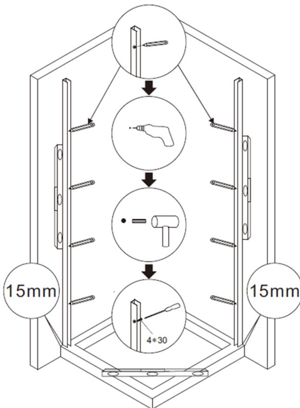
Utilizzare le viti 4x30 per fissare le guide di alluminio in alto e in basso. (come nell'immagine)
