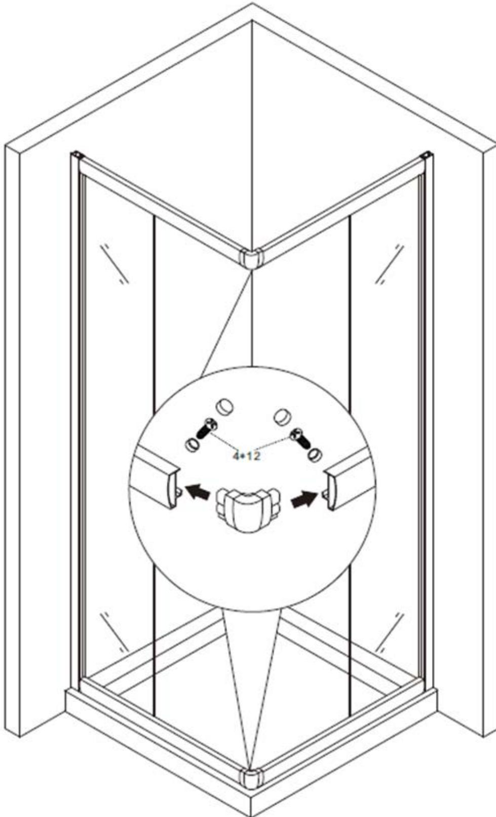
Installez les roulettes supérieures et inférieures sur les portes en verre, les roulettes avec boutons ressort sont pour le bas, les roulettes sans boutons ressort sont pour le haut.
