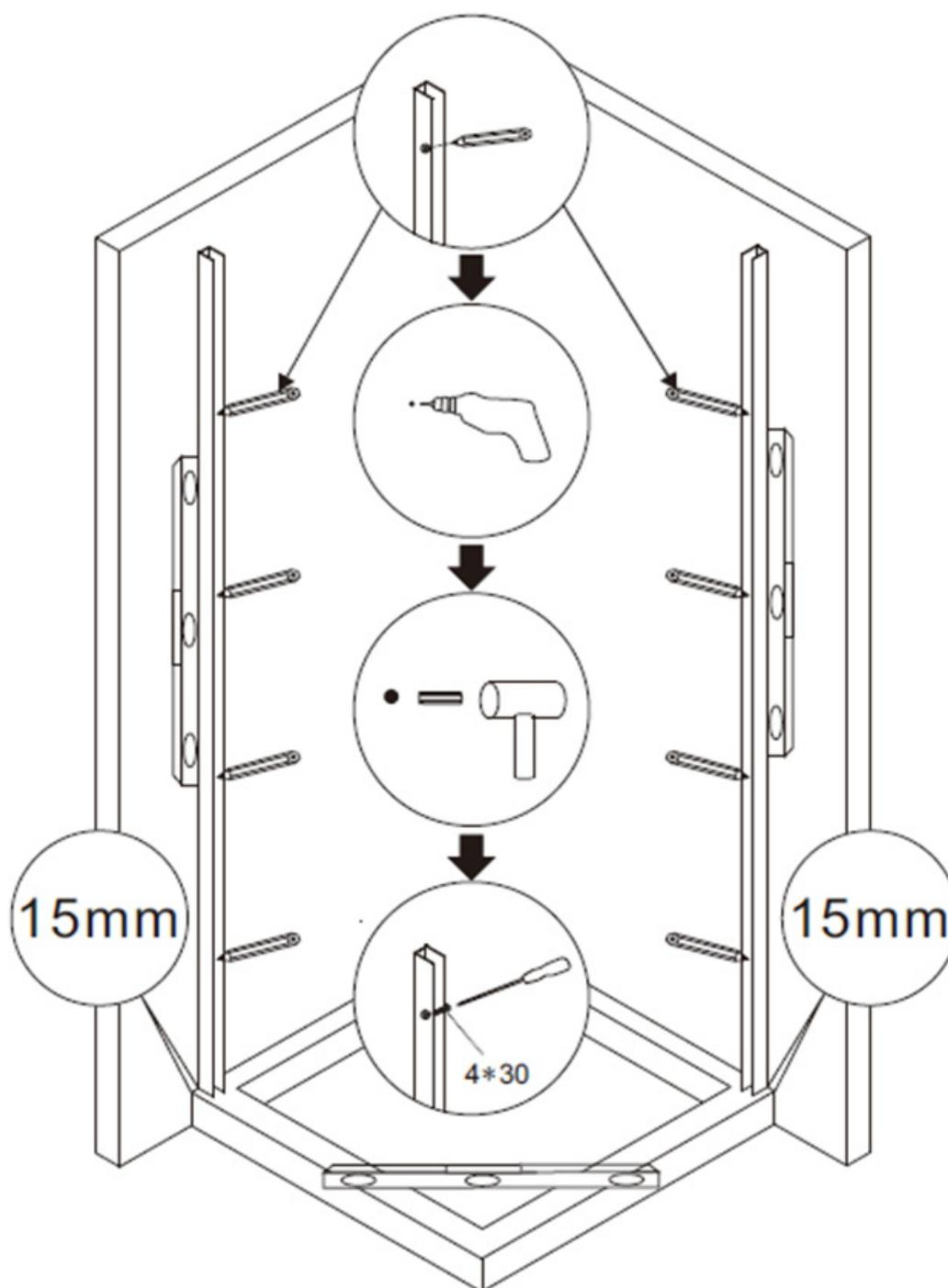
Utilisez les vis 4x30 pour relier les rails en aluminium supérieur et inférieur au profilé en aluminium comme ci-dessous.
