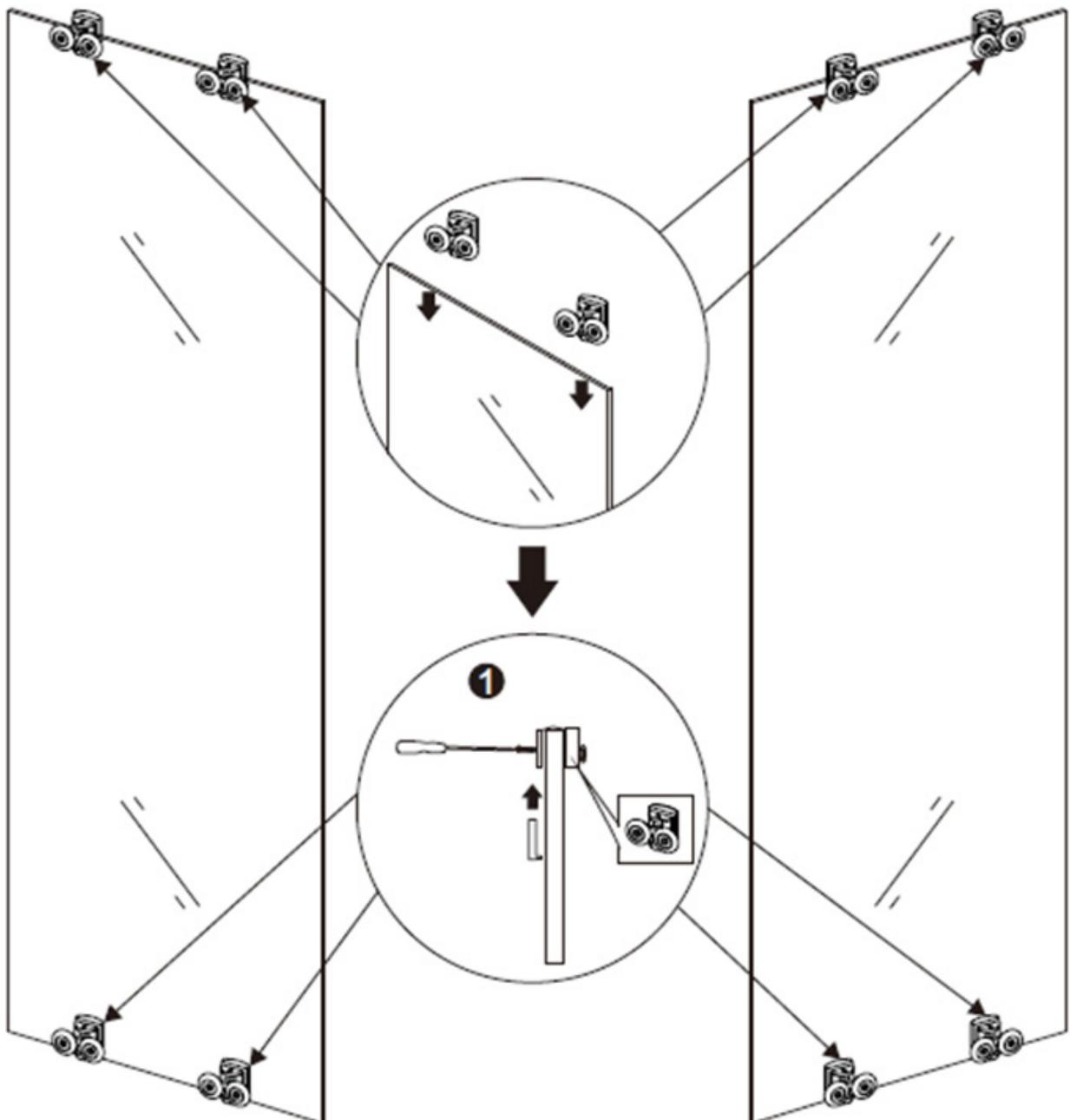
Führen Sie nun die Glastüren in die Aluminiumschiene (s. Abbildung)
