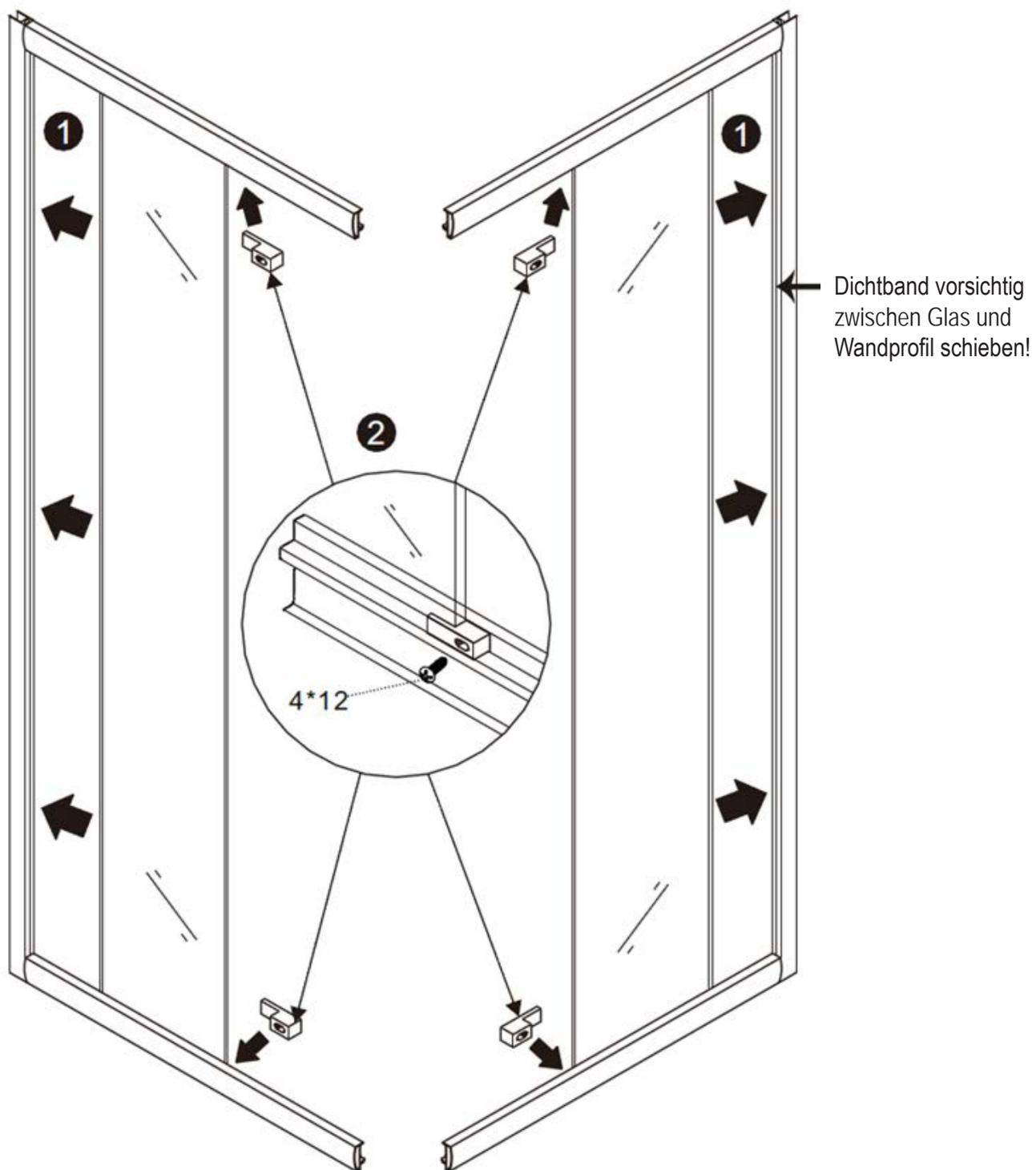
Installieren Sie den Rahmen in die Aluminium Wandprofile (s. Abbildung)
