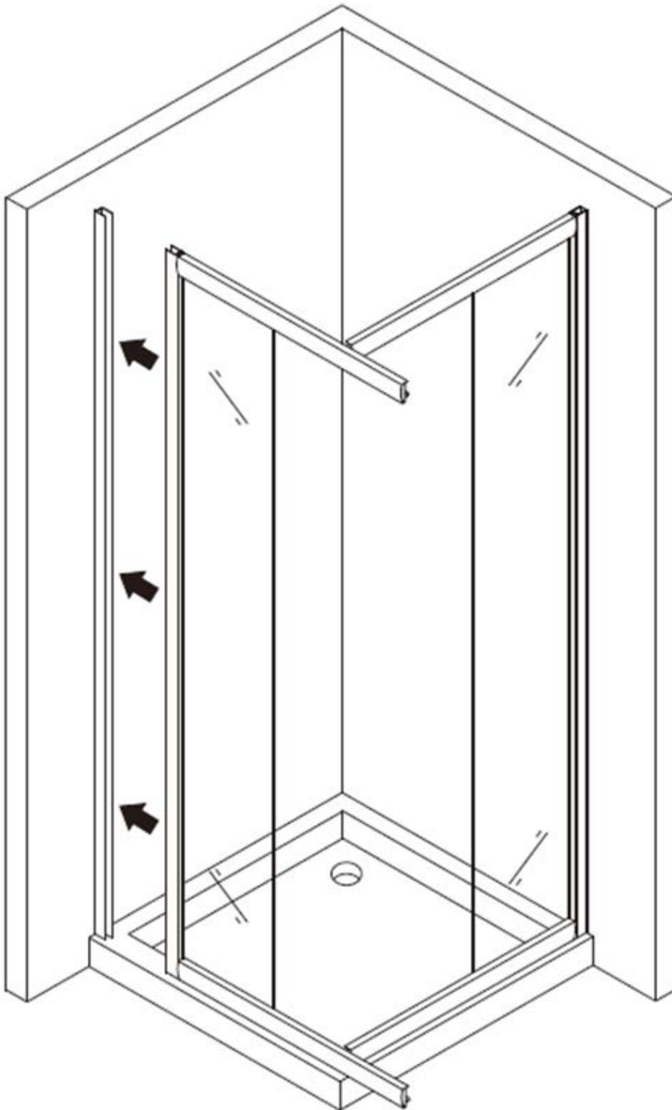
Jetzt verbinden Sie beide Seiten mit Hilfe des Kunststoffwinkels (s. Abbildung)
