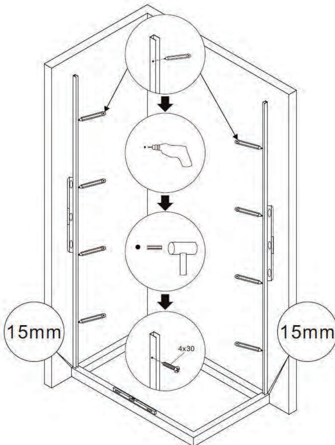
Utilisez des vis 4x30, pour fixer en haut et en bas le Profil en aluminium avec le rail en aluminium.
