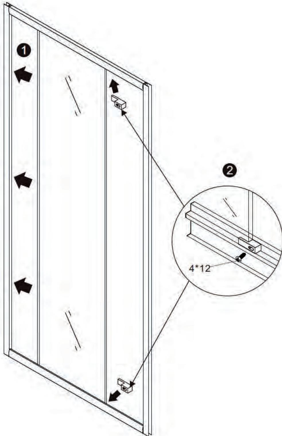
1. Utilisez les vis 4x30 pour fixer le cadre au mur
