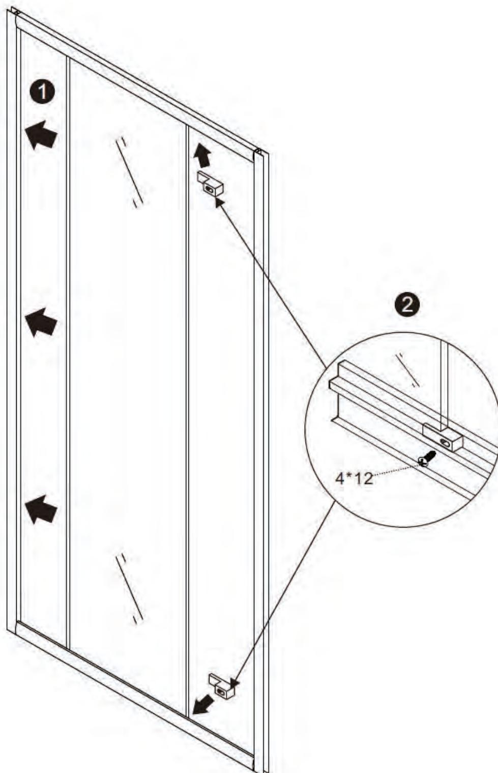
1. Verwenden Sie die 4x30 Schrauben, um den Rahmen an der Wand zu befestigen.
