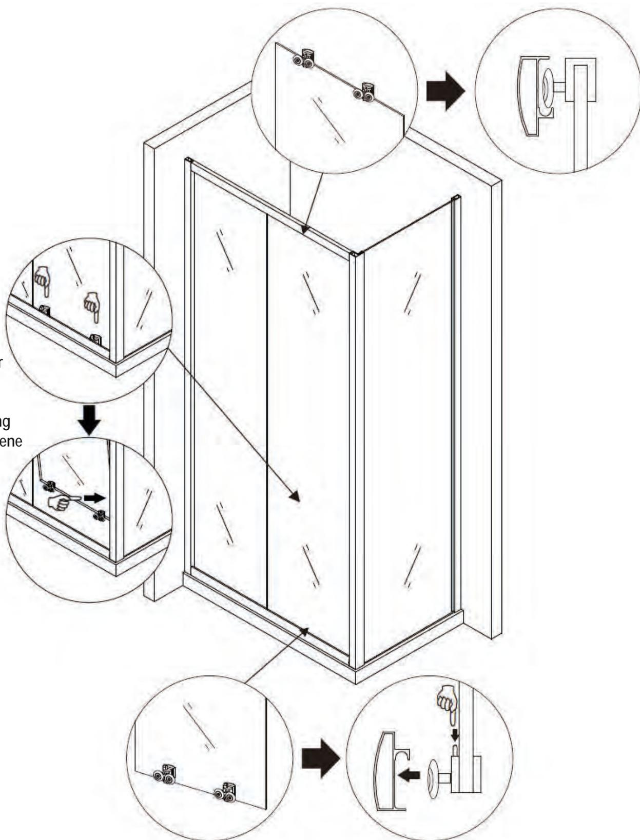
1. Installieren Sie die Magnetdichtungen an die Glastür.
