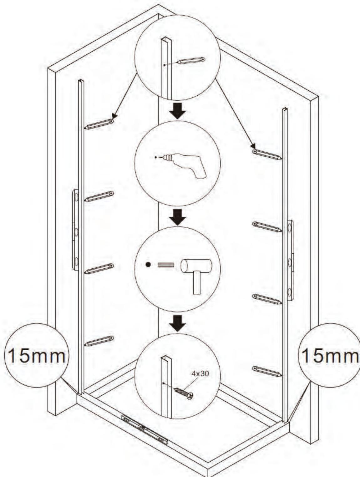
Verwenden Sie die 4x30 Schrauben, um das Aluminium-Profil von unten und oben mit der Aluminiumschiene zu verschrauben.
