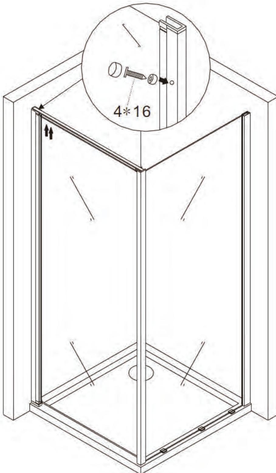
1. Installieren Sie die Alu-Leiste am Boden/auf der Duschtasse wie auf der Abbildung zu sehen.
