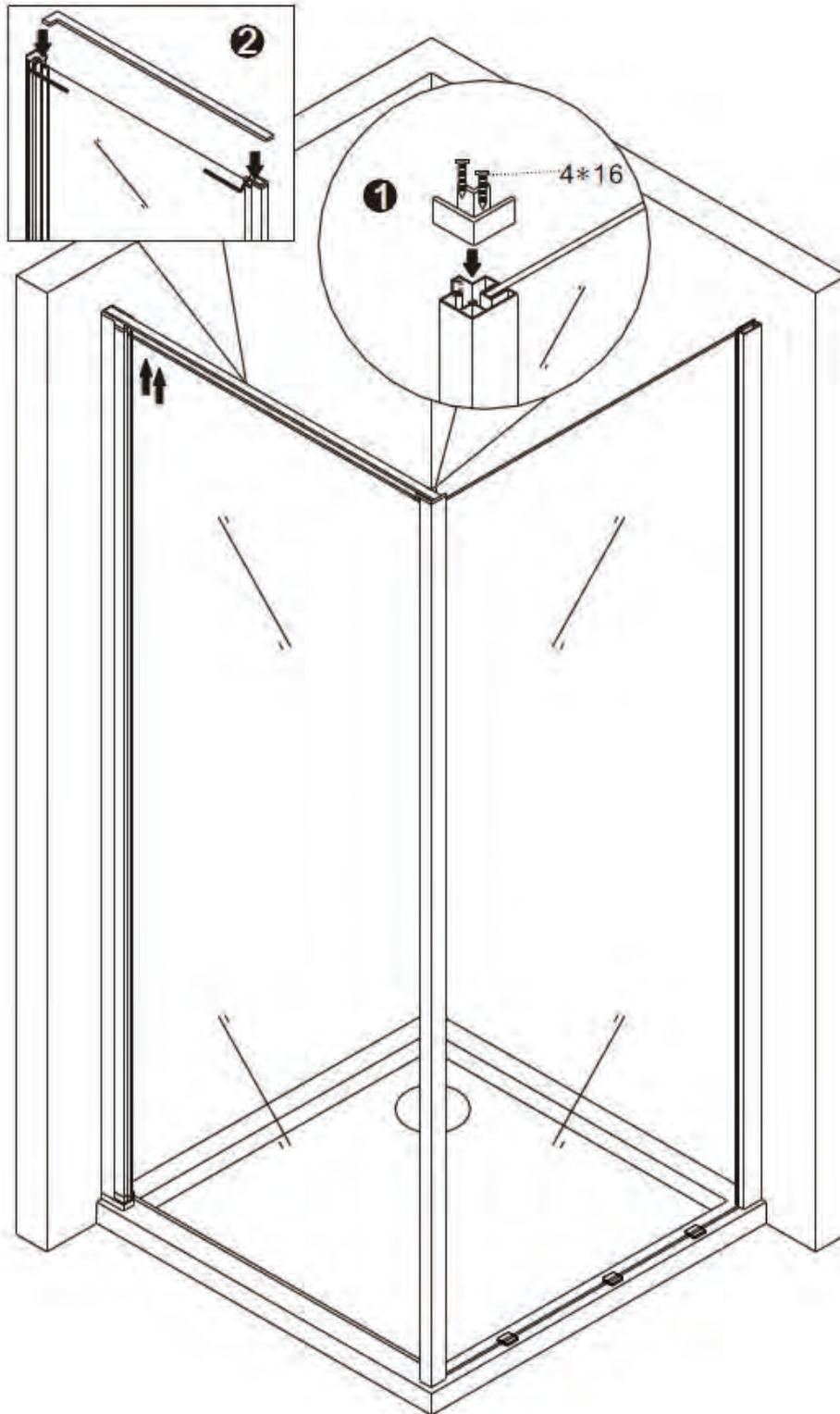
1. Installieren Sie die Dichtung zwischen festem Gals und Aluminium Profil.
