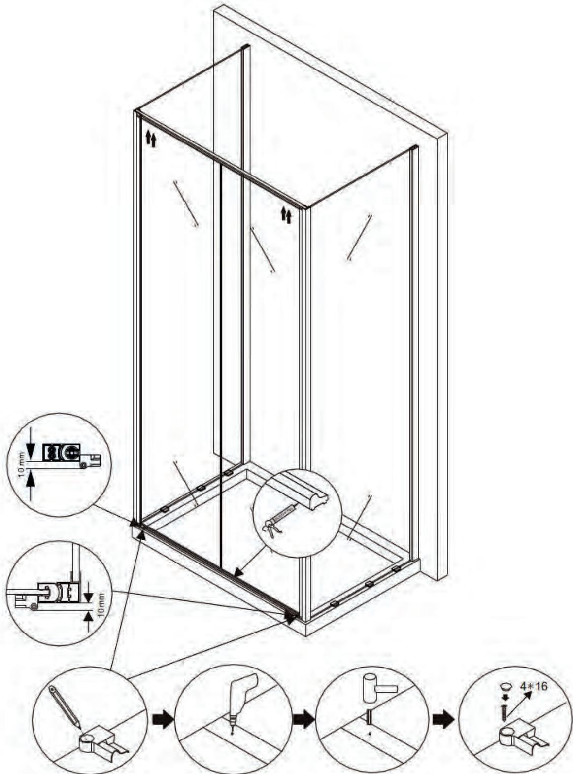
Fixez le coin du profilé et le profil de la paroi de verre avec des vis 4x16.
