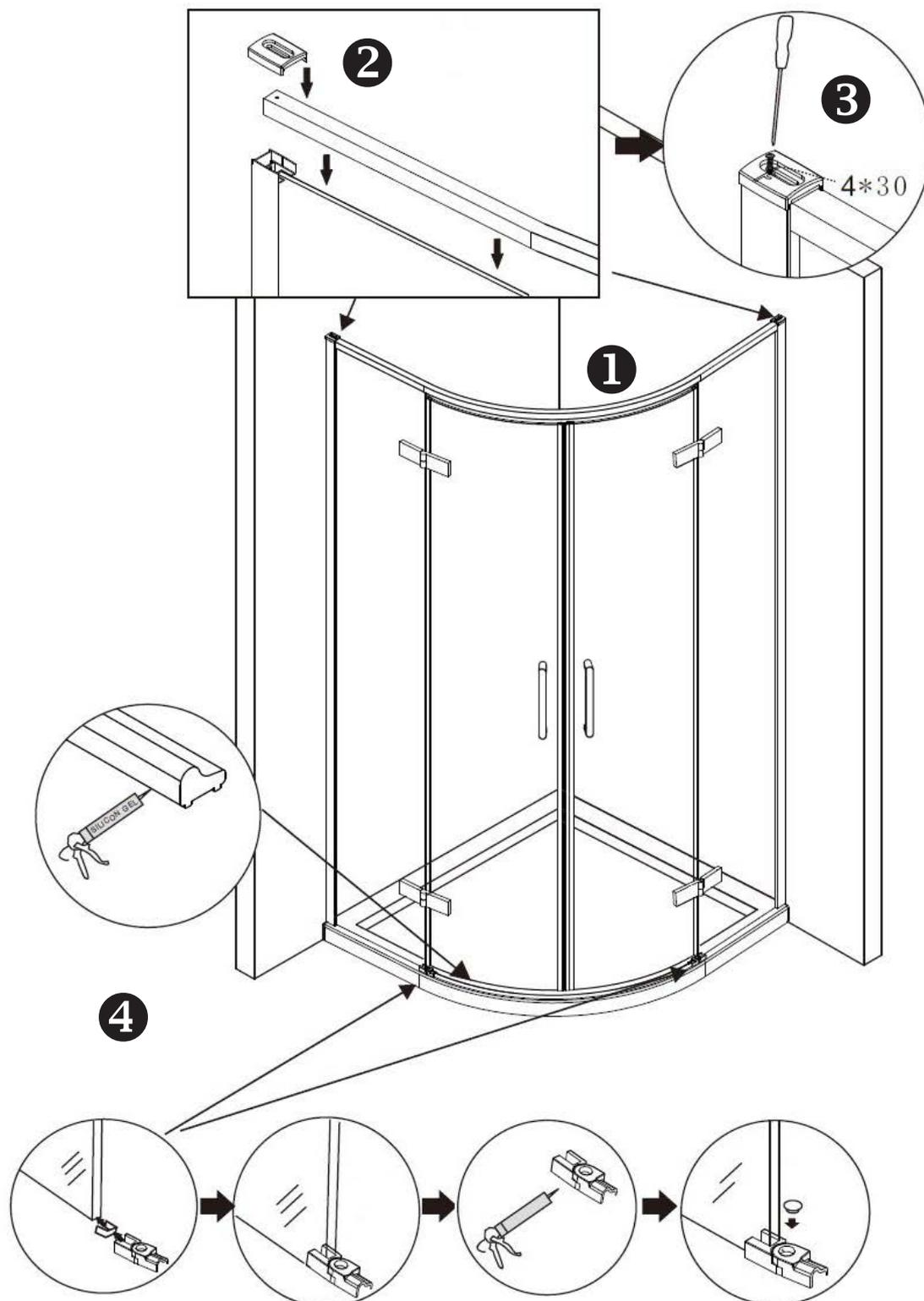
1. Fixieren Sie die Stabilisierungsschiene jeweils am Ende der feststehenden Seitenelemente mit dem beigefügten Sechskantschlüssel.
