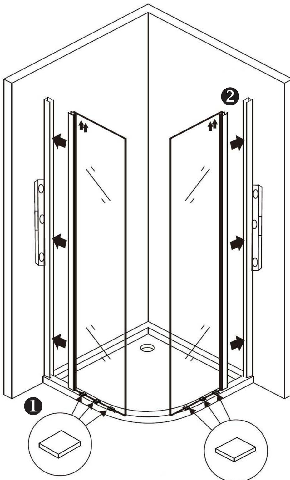
1. Verschrauben Sie von innen die tragenden Scharniere für die Glastüren mit den festen Glaselementen.
