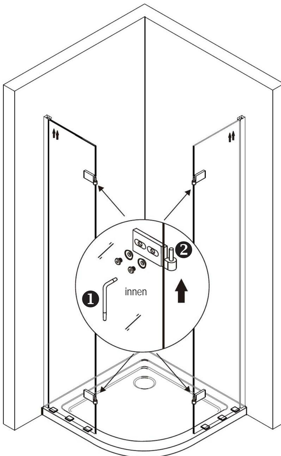
1. Schieben Sie die Magnetverschußleisten auf die Enden der Glastüren.
