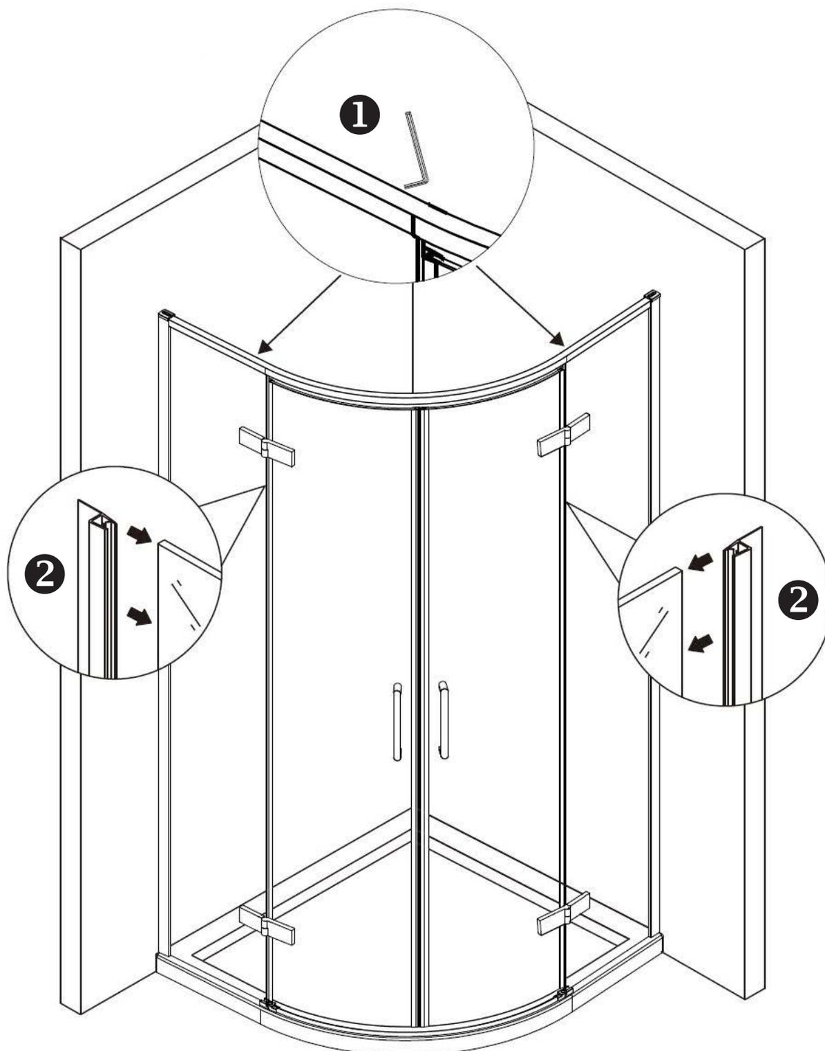
1. Platzieren Sie die unteren Türdichtungen.
