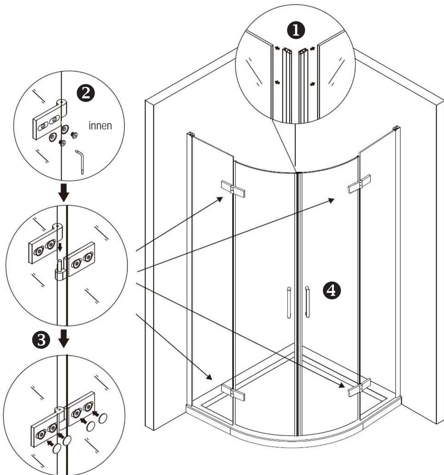
1. Setzen Sie die Stabilisierungsschiene parallel zu den Glaselementen auf die Duschkabine.
