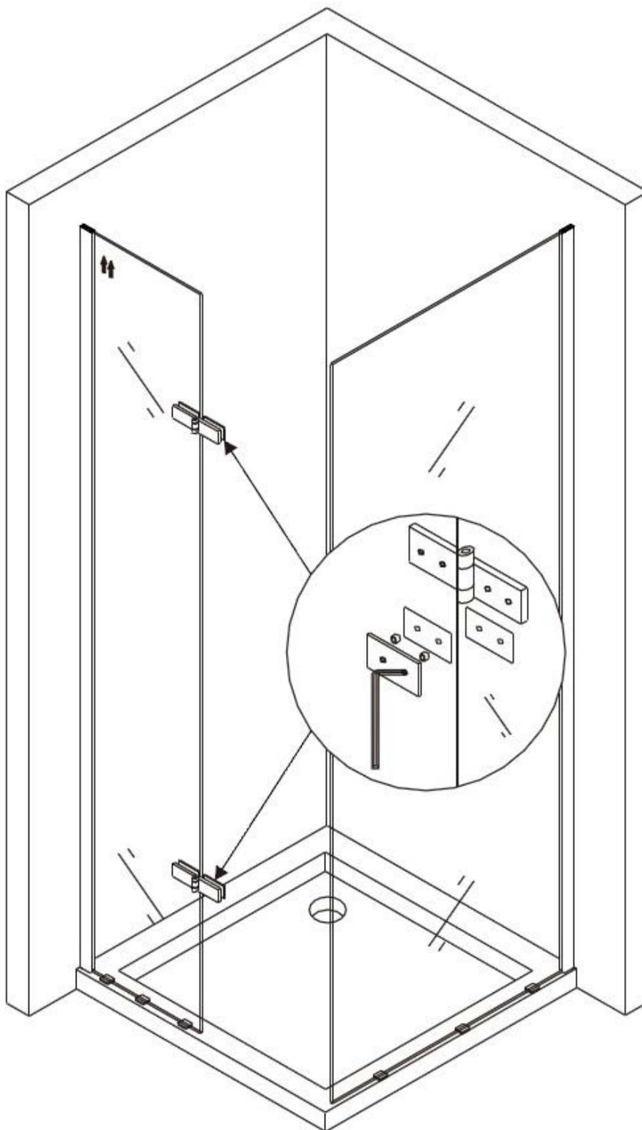
Fixez vous le voyez en dessous, les portes de verre à l'aide des charnières (1) et fixer les bandes magnétiques et les bandes en caoutchouc sur les éléments en verre.
