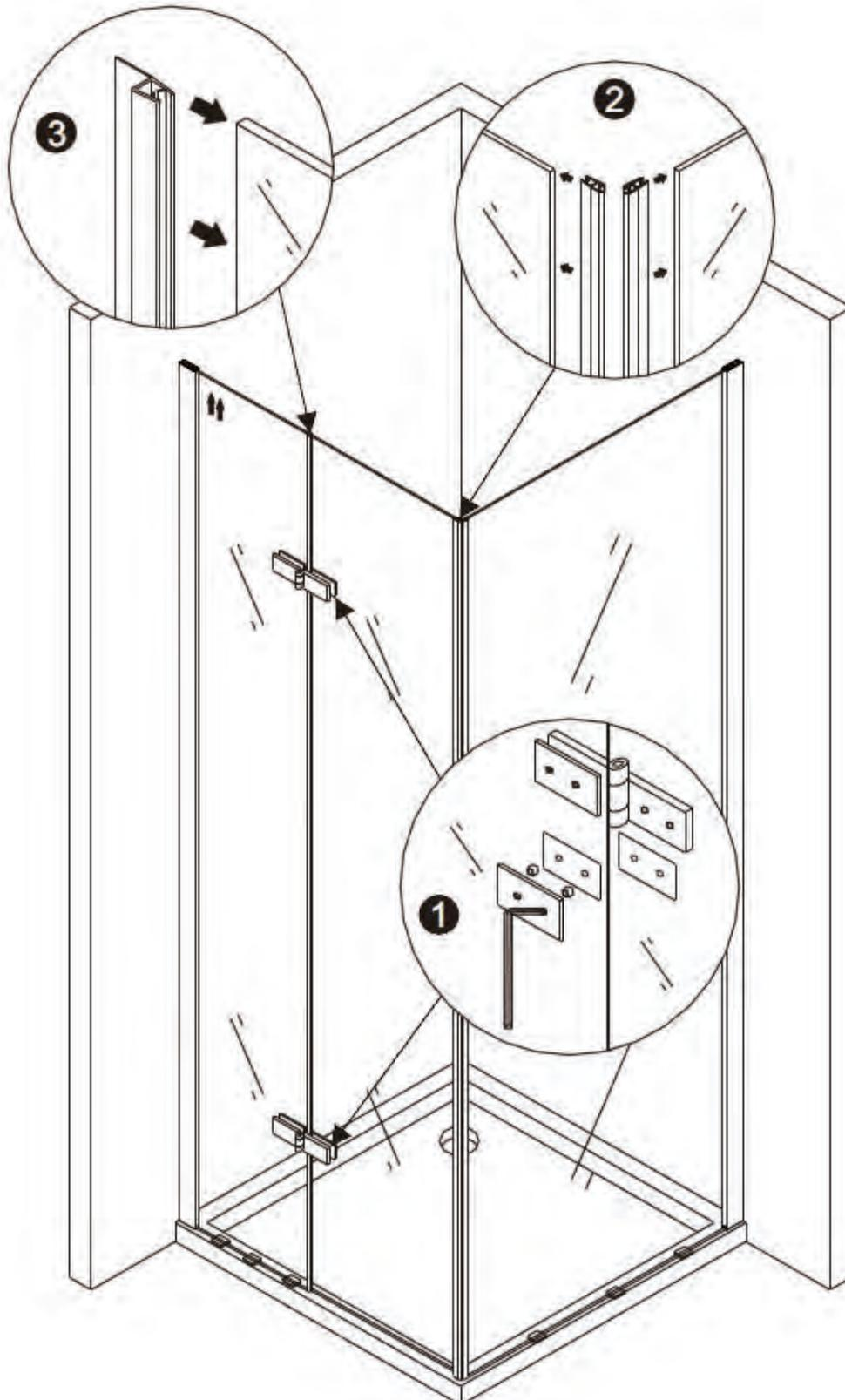
Bohren Sie die Löcher und verschrauben Sie anschließend das feste Glaselement mit dem Wand-Aluminium-Profil.
