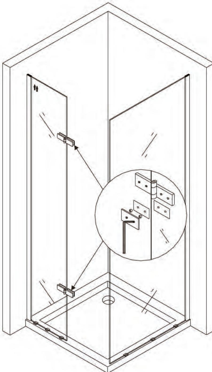
Befestigen Sie, wie in der Abbildung unten zu sehen ist, die Glastüren durch die Scharniere (1) und setzen Sie anschließend die Magnet- (2) sowie die Gummileisten (3) an die Glaselemente.
