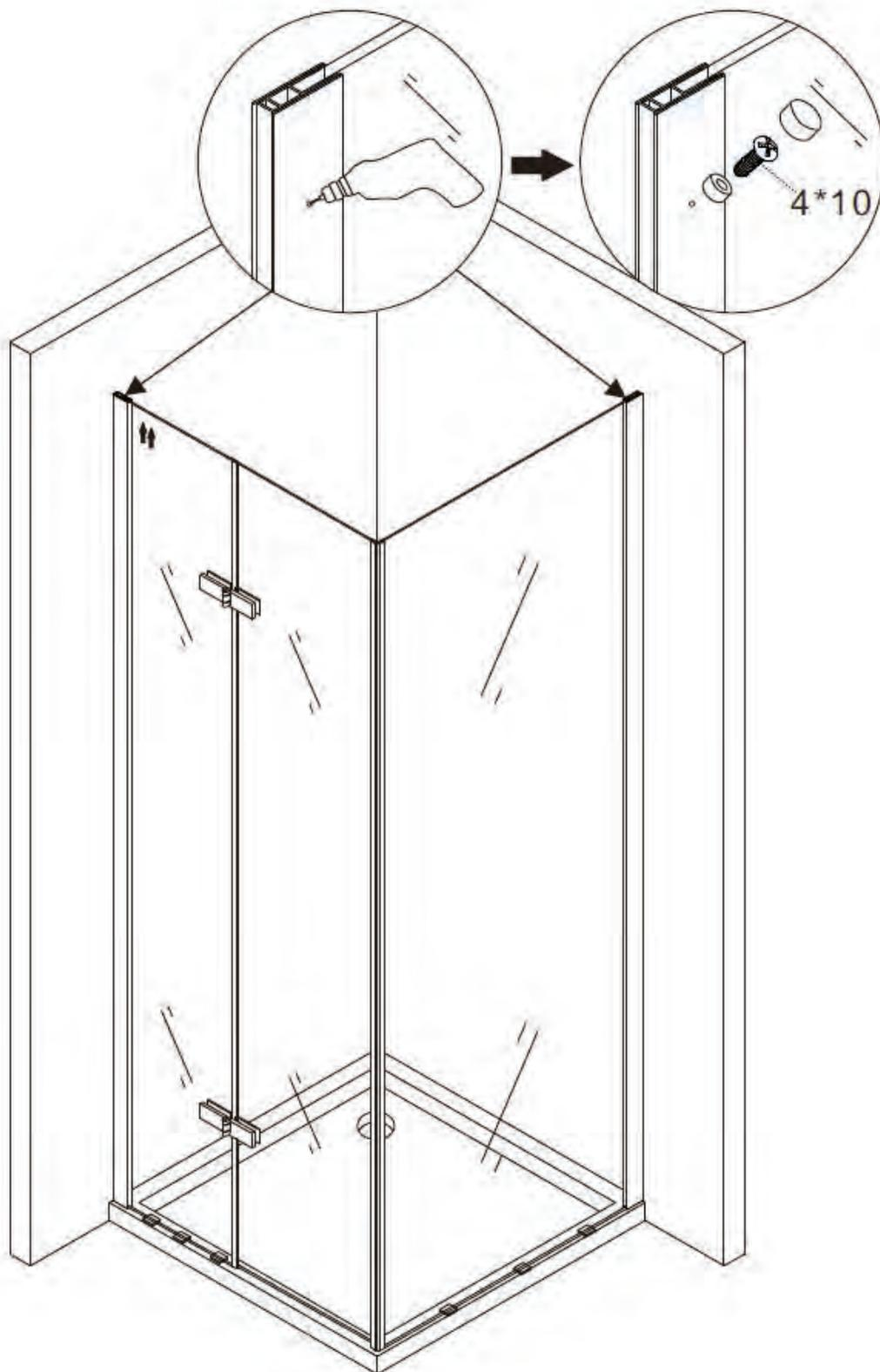
1. Installieren Sie die Aluminium Dichtung, wie auf der Abbildung unten zu sehen ist.
