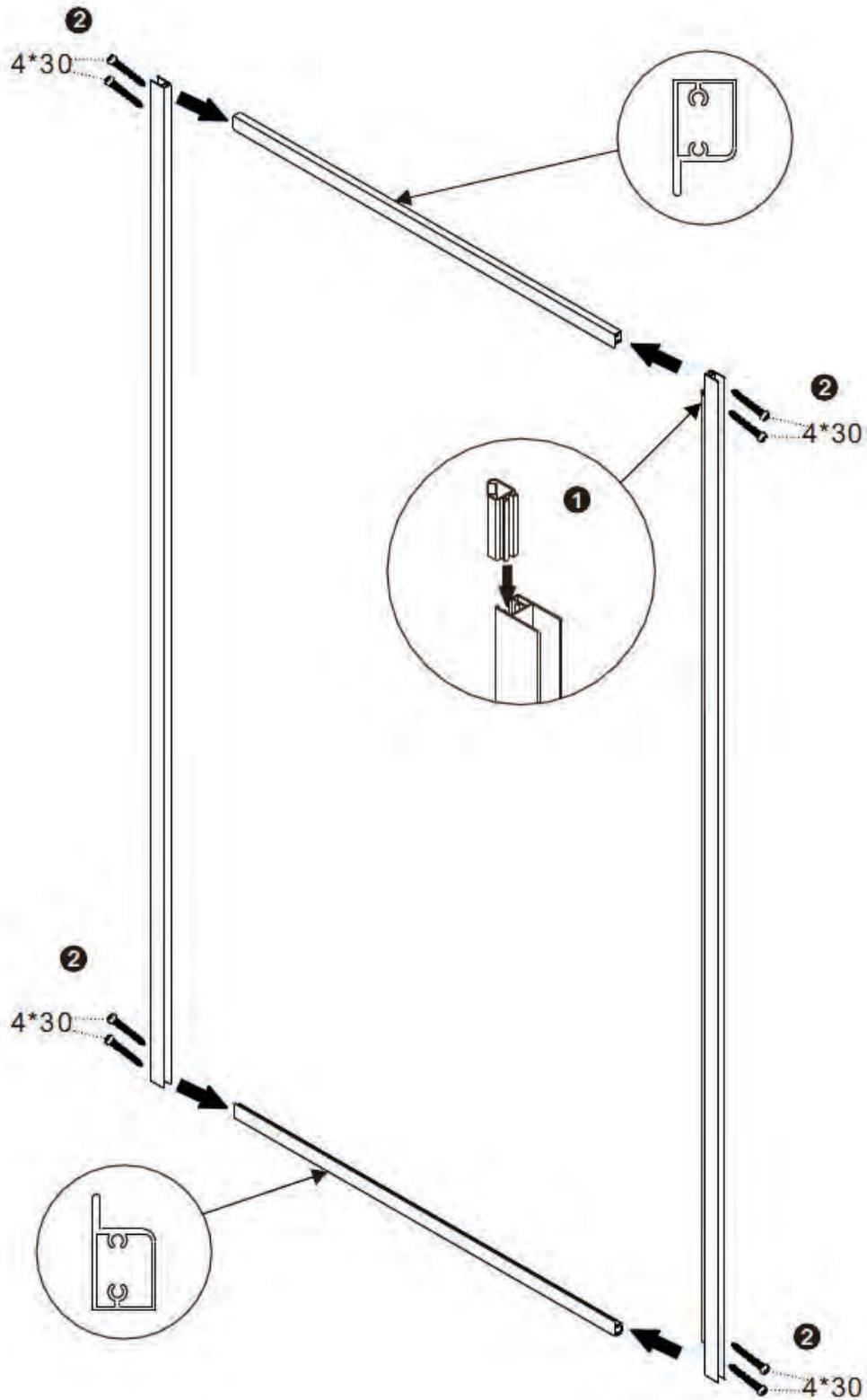
Integrieren Sie das Wand-Aluminium-Profil mit dem kombinierten Rahmen.
