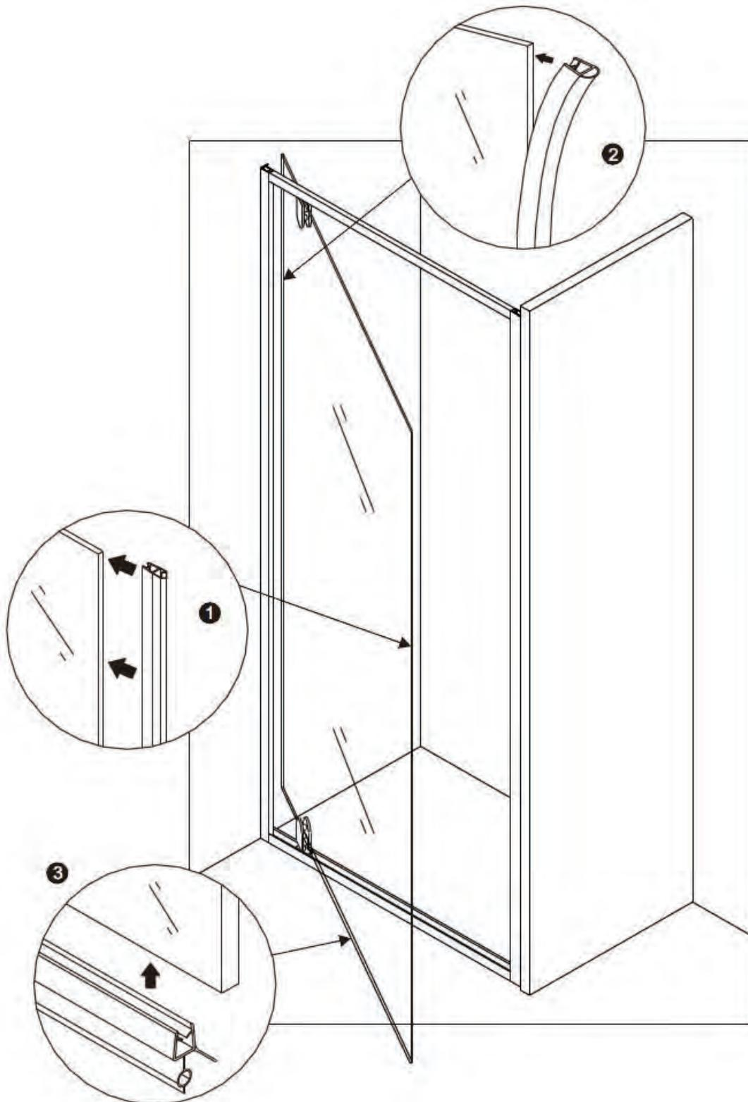
Verwenden Sie 4x16 Madenschrauben, um das Aluminium-Profil auf beiden Seiten zu verschrauben.
