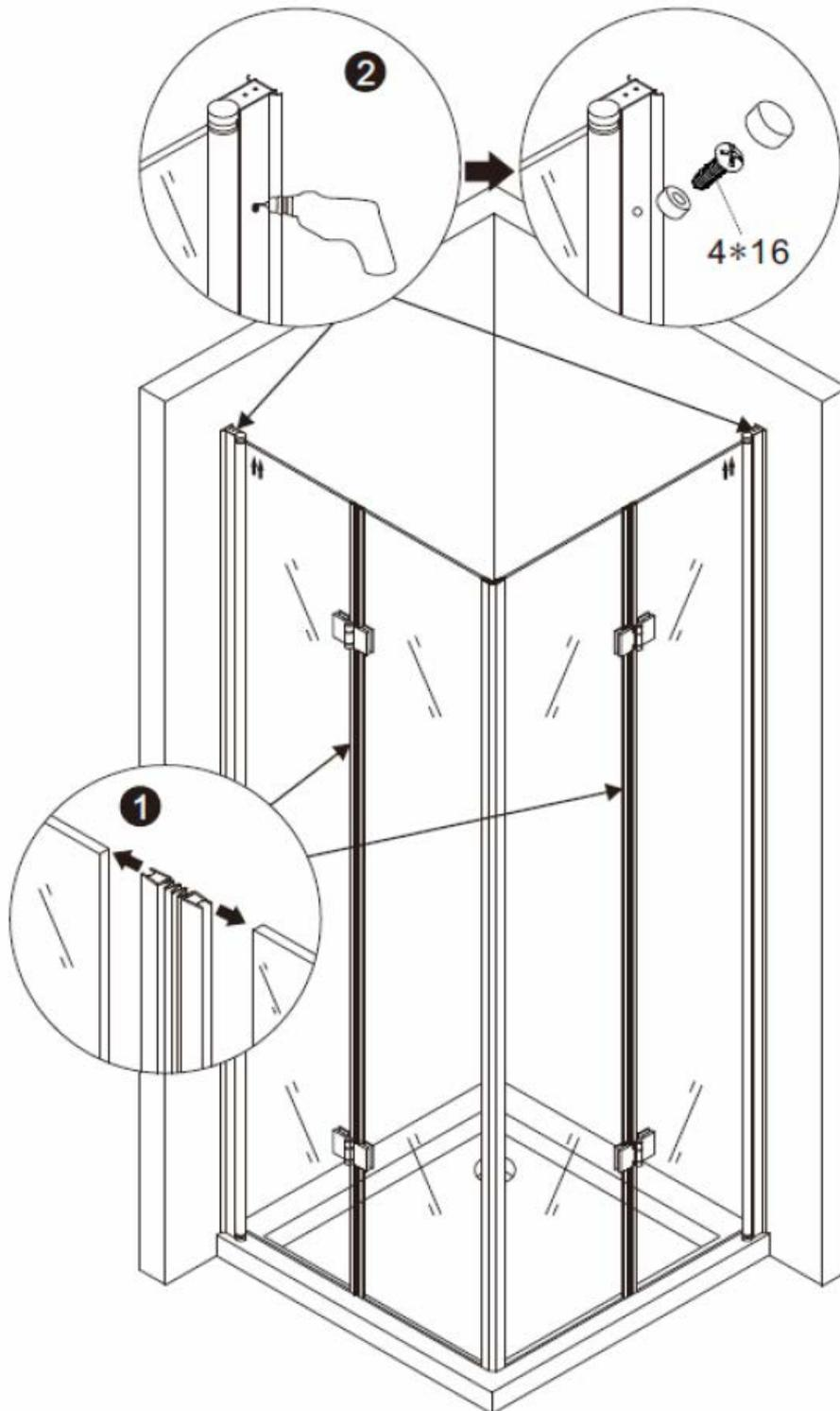
Fixieren Sie die Aluminium Dichtung wie auf dem Bild zu sehen, mit Hilfe der Kunststoffhalterungen auf der Wanne. Spritzen Sie das Silikon unter die Dichtung (siehe Bild).
