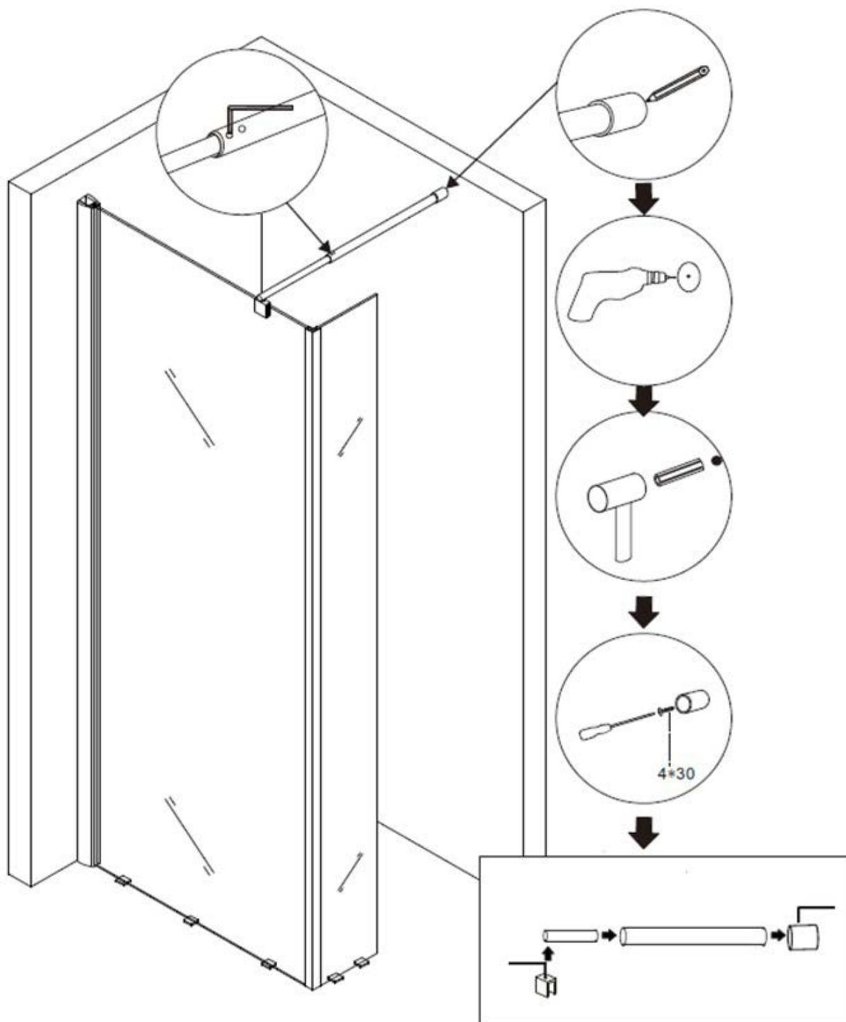
1. Mettez le couvercle de protection sur le profilé en aluminium et scellez la paroi comme ci-dessous avec du silicone.
