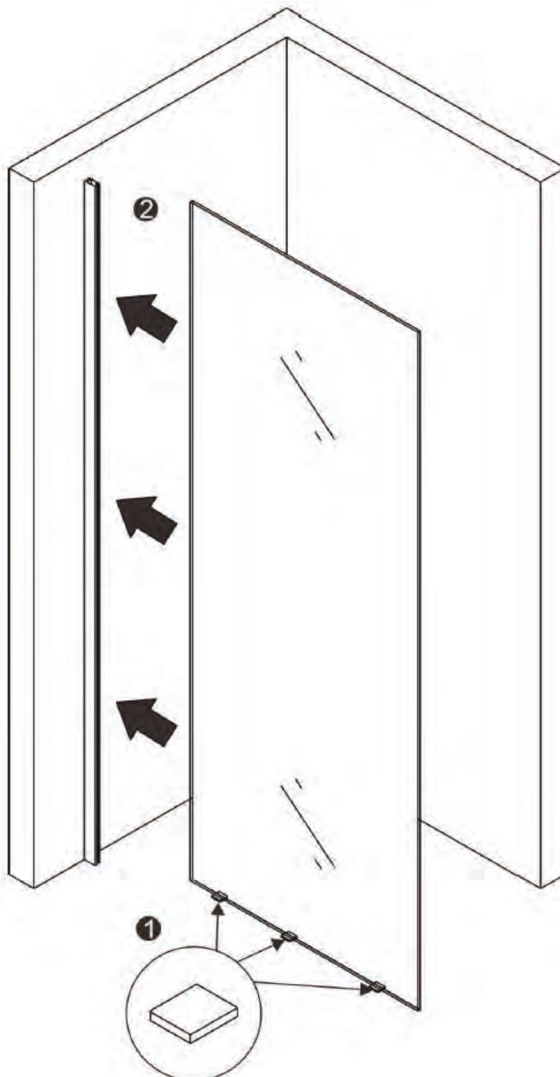
Installieren Sie die Dichtung zwischen festem Glas und Aluminium Profil.
