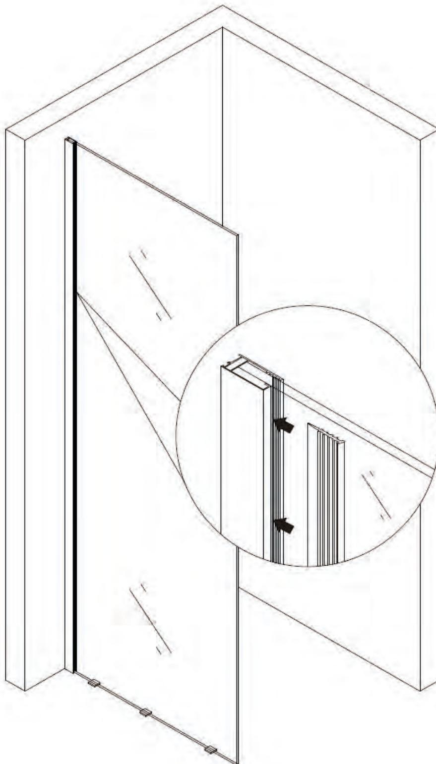
Setzen Sie nun die Haltestange zwischen Wand und Glas und verschrauben Sie diese wie auf dem Bild zu sehen.
