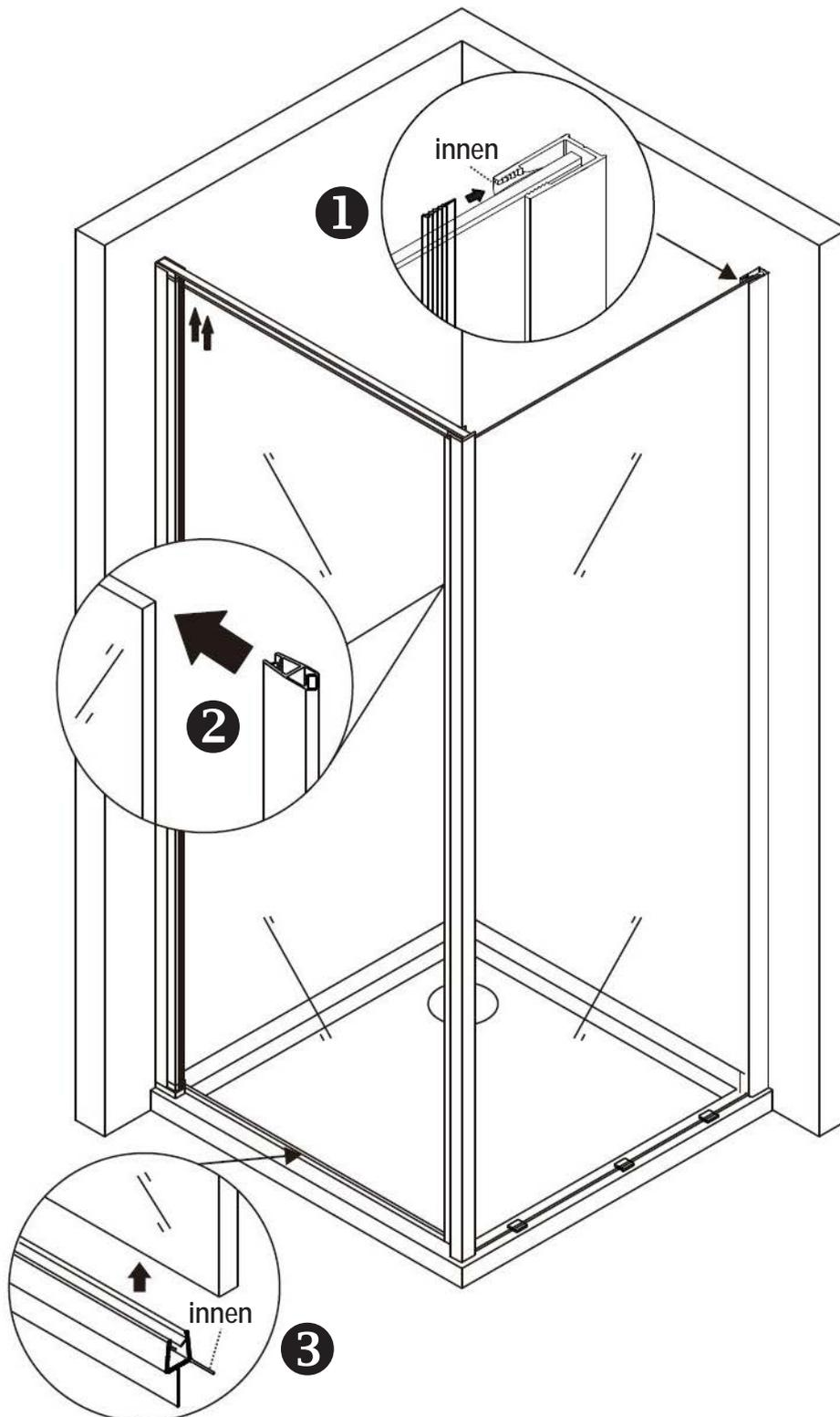
1. Befestigen Sie die Aluminiumschiene und das Profil der Glastür mit den Schrauben, wie in der Abbildung unten zu sehen.
