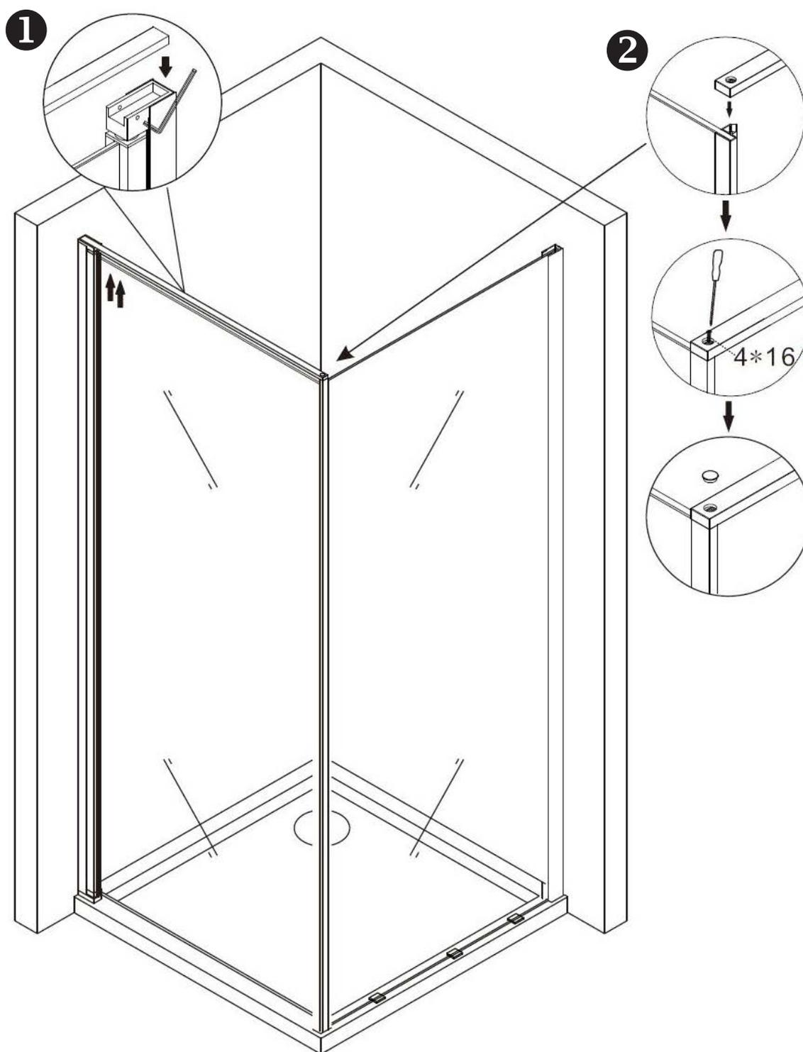
1. Installieren Sie die Dichtung zwischen dem festen Glaselement und dem Aluminiumprofil.
