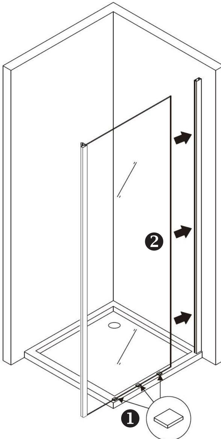
1. Richten Sie auch die Aluminiumschiene, wie auf dem Bild unten zu sehen, mit der Wasserwaage aus und markieren Sie die Bohrlöcher mit einem Stift.
