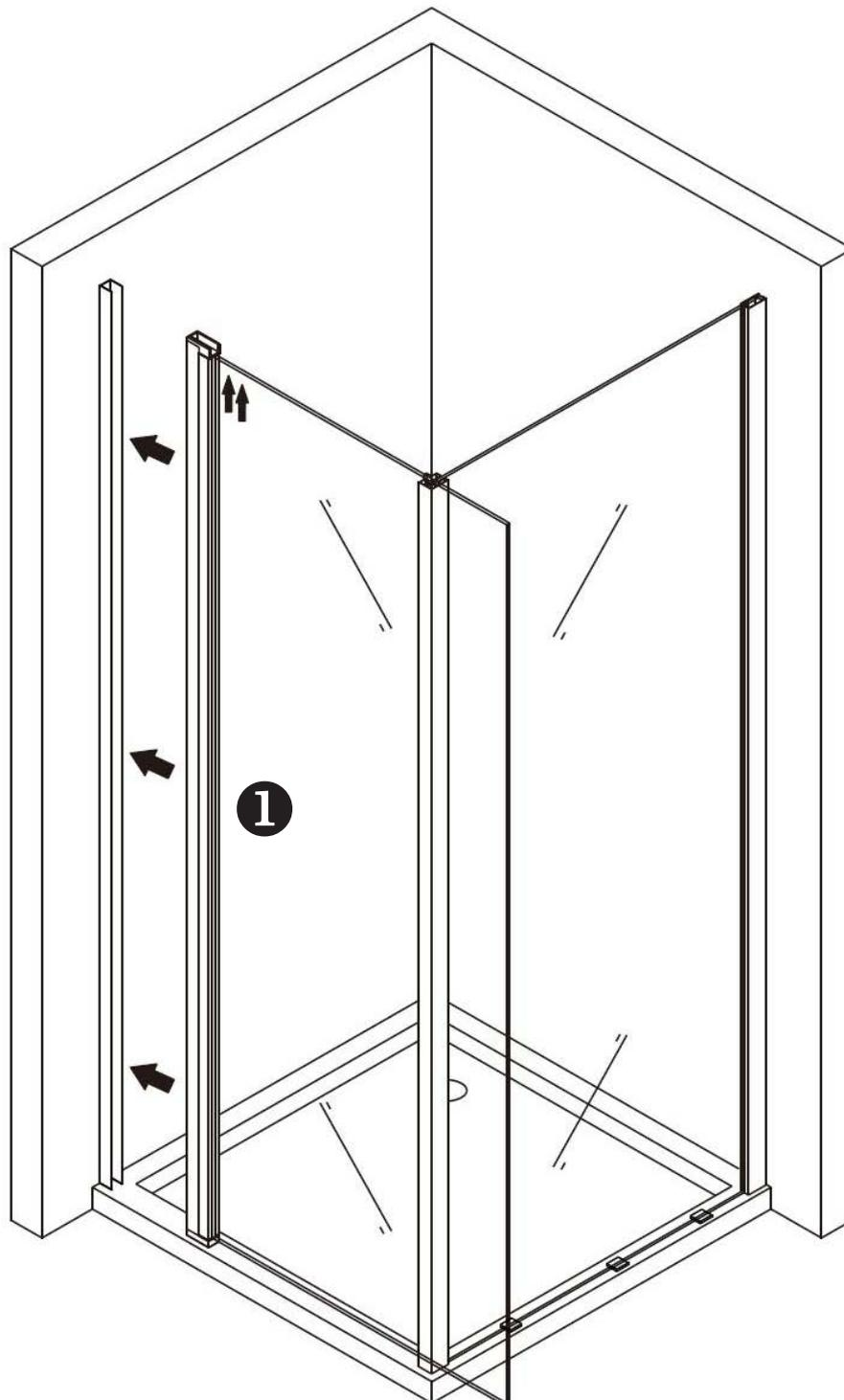
1. Montieren Sie die verzinkte Leiste um das Aluminium-Wandprofil mit dem Aluminium-Eckprofil zu verbinden.
