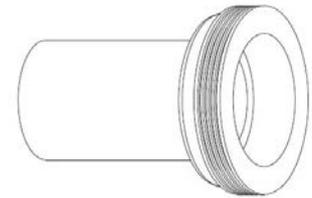
Ablaufrohr mit Dichtungsring
