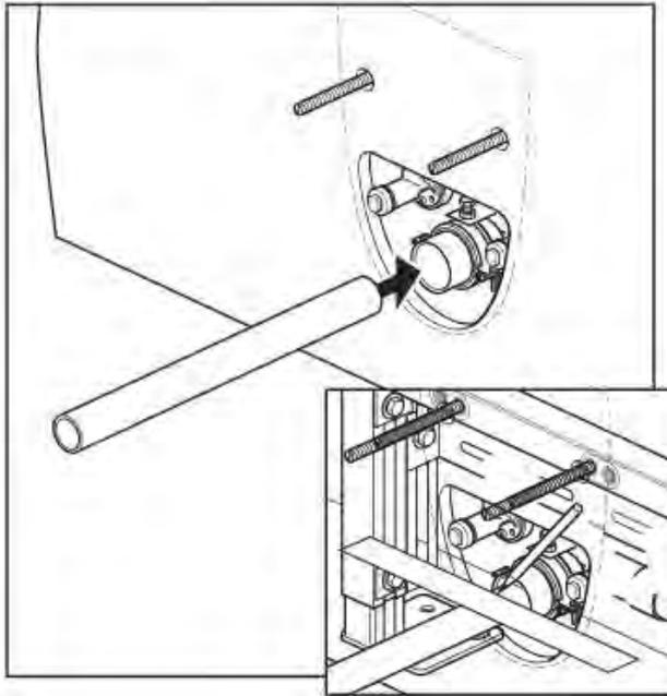
Schieben Sie das Ablaufrohr bis zum Anschlag in den Ablaufbogen. Legen Sie eine gerade Kante bündig an die Trennwand (wie abgebildet) und markieren Sie den Abschluss auf dem Ablaufrohr. Entnehmen Sie das Ablaufrohr.
