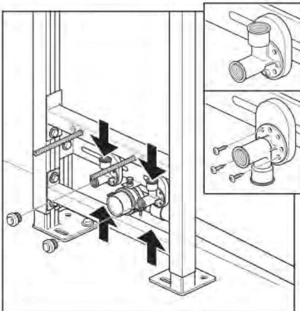
Verbinden Sie die Warm- und Kaltwasserleitung mit den Zulaufanschlüssen ( $\text{\O} \frac{1}{2}''$ ) und schrauben Sie die Blindstopfen in die Anschlussenden. Die Innengewinde müssen möglicherweise verlängert werden (abhängig von der Fliesendicke usw.). Die Zulaufanschlüsse können je nach Rohrleitung gedreht werden. Es ist notwendig, für die Installation der Armatur zentrale Absperrventile vorzusehen.
