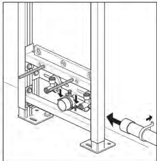
Bereiten Sie das Abflussrohr vor und schließen Sie es an (ein aufsteckbarer Abfluss wird empfohlen). **Hinweis:** Der Ablaufbogen kann gedreht werden, um die Abwasserleitung aufzunehmen, indem die gezeigten Schrauben gelöst werden. Fixieren Sie das Abflussrohr an der Wand.
