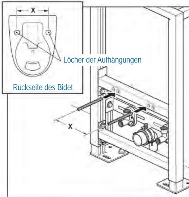
Den Abstand 'X' zwischen den Mitten der Befestigungsöffnungen messen. Drehen Sie die Gewindebolzen in die entsprechenden Löcher der Haltestange (innen oder außen) ein. Die Gewindebolzen können mit einem großen Schraubendreher eingestellt und bei Bedarf abgelängt werden.
