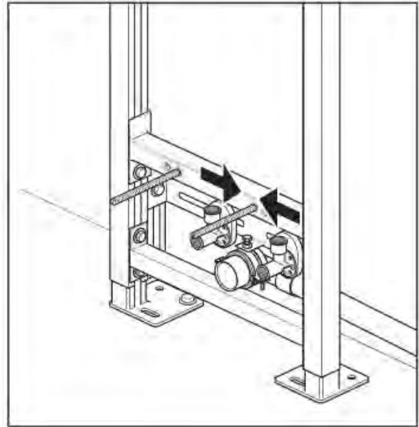
Lösen Sie die Zuläufe der Warm- und Kaltwasserleitungen (mit den Muttern an der Rückseite). Stellen Sie den erforderlichen Abstand ein, um einen einfachen Anschluss der Armatur zu ermöglichen und ziehen Sie die Muttern wieder fest.
