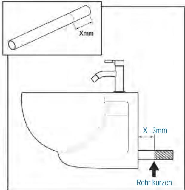
Messen Sie die markierte Länge des Ablaufrohrs (Xmm). Dieser Betrag abzüglich 3mm ist die Endlänge des Abflussrohrs und muss von der Rückseite des Bidet in den Ablaufbogen reichen. Schneiden Sie das Ablaufrohr ab und entfernen Sie alle Grate.
