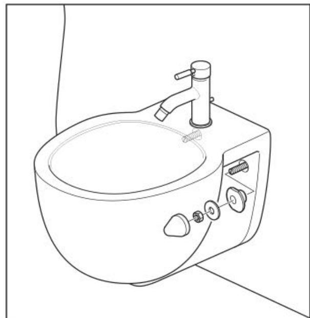
Positionieren Sie die Distanzhülsen und Unterlegscheiben vorsichtig auf den Bidet-Gewindebolzen. Ziehen Sie die Muttern an und platzieren Sie die Kunststoffabdeckungen.
