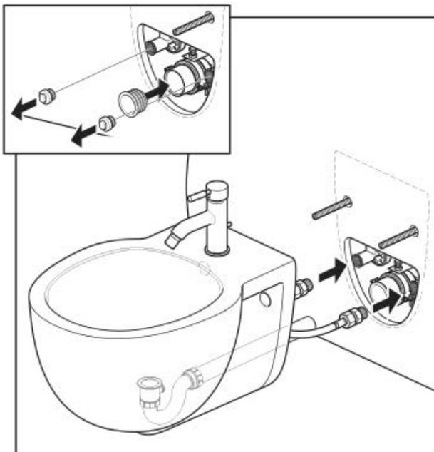
Positionieren Sie das Bidet vorsichtig auf die Gewindebolzen. Entfernen Sie die Blindstopfen und schließen Sie die flexiblen Warm- und Kaltzuläufe an. Für die Einlassbögen sind möglicherweise Adapter erforderlich. Schmieren Sie die Ablaufdichtung innen und schieben Sie das Ablaufrohr in den Ablaufbogen. Ziehen Sie alle Verbindungen fest an. **Hinweis:** Die Gewindebolzen können mit einem Schraubendreher nachgestellt werden.
