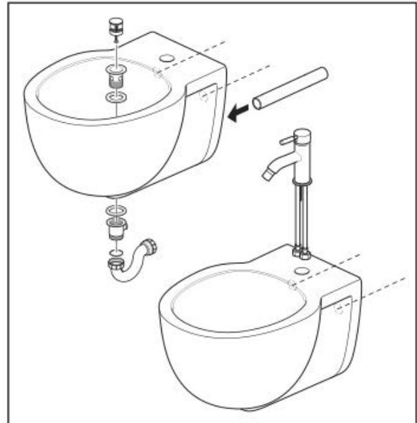
Befestigen Sie Siphon, Ablaufrohr und die Armatur am Bidet. **Hinweis:** Es wird hier ein verstellbarer Abfluss mit Pop-Up dargestellt. Die Höhe des Siphon ist vertikal einstellbar. Stellen Sie ihn so ein, dass er in der Endmontage leicht nach oben und unten verstellt werden kann.
