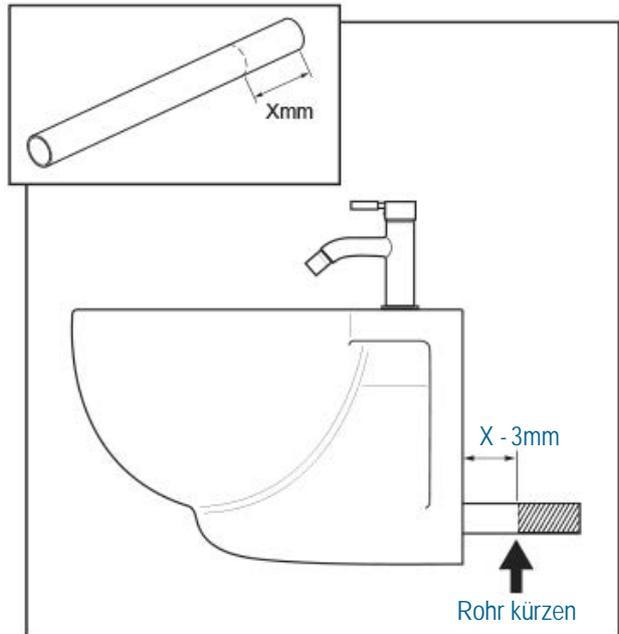
Messen Sie die markierte Länge des Ablaufrohrs (Xmm). Dieser Betrag abzüglich 3mm ist die Endlänge des Abflussrohrs und muss von der Rückseite des Bidet in den Ablaufbogen reichen. Schneiden Sie das Ablaufrohr ab und entfernen Sie alle Grate.
