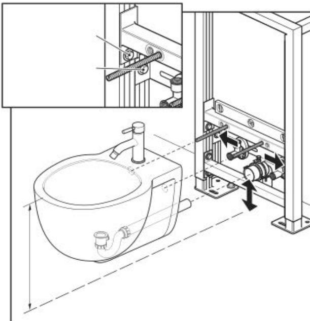
Heben Sie das Bidet auf die vorbereiteten Gewindebolzen. Lösen Sie die Schrauben zur Einstellung der Verbindungshöhe und stellen Sie die Verbindungsstütze auf die erforderliche Höhe ein, um sie mit dem Abfluss auszurichten. Ziehen Sie die Schrauben an. Entfernen Sie das Bidet wieder.
