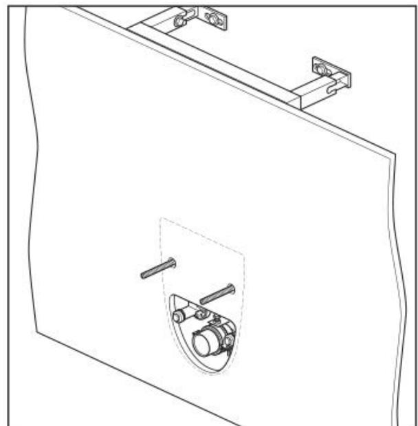
Stellen Sie nun die Trennwand und bohren Sie die Löcher und Durchbrüche für die Gewindebolzen, Anschlüsse und Abflussrohr. Fliesen Sie die Oberfläche oder tragen Sie das Finish jetzt auf.
