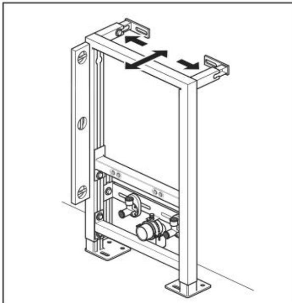
Stellen Sie den gewünschten Wandabstand ein. Dazu lösen Sie die Schrauben und schieben die Halterungen auf den erforderlichen Abstand. Prüfen Sie, ob der Rahmen vertikal in der Waage ist und ziehen Sie die Schrauben wieder fest.
