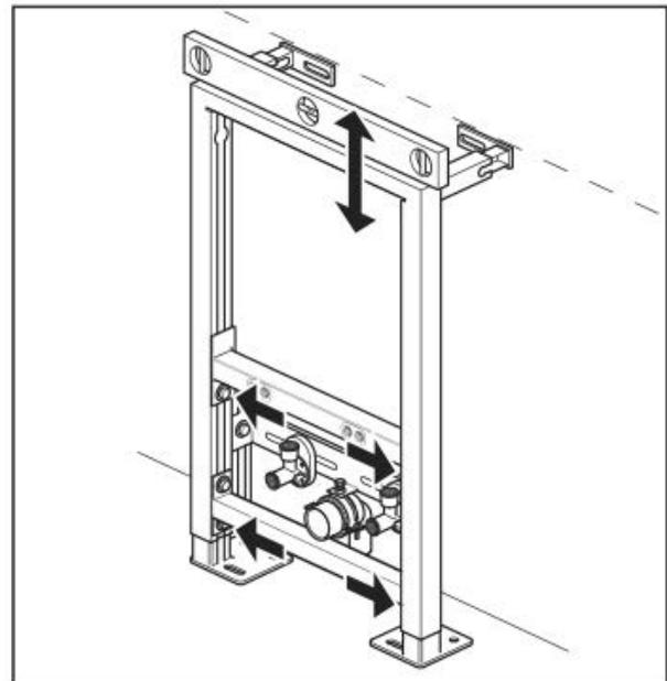
Stellen Sie den Rahmen in der geplanten Position an die Wand. Lösen Sie die Höhenverstellerschrauben und stellen Sie die gewünschte Höhe ein. Prüfen Sie, ob der Rahmen horizontal in der Waage ist und ziehen Sie die Schrauben fest.
