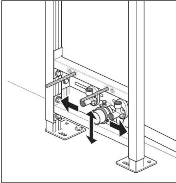
Lösen Sie die Einstellschrauben der Querstangenhalterung. Heben Sie die Querstangenstütze so hoch wie möglich an (unter den Ablaufbogen) und ziehen Sie beide Schrauben wieder fest. Dies bietet zusätzliche Unterstützung für das Bidet.
