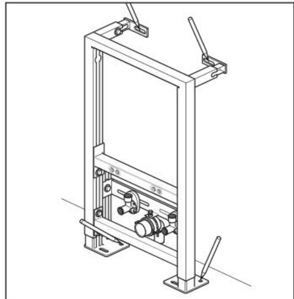
Markieren Sie die Befestigungspositionen an Wand und Boden. Entfernen Sie den Rahmen und bohren Sie die Löcher für die Halterungen vor. Befestigen Sie den Rahmen mit Schrauben und Dübeln an Wand und Boden. Überprüfen Sie, ob der Rahmen in allen Richtungen in der Waage ist.
