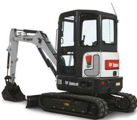
Leistungsstarker Minibagger mit Dieselmotor. Der Bagger verfügt über ein geschlossene Kabine mit Heizung. Arbeitsscheinwerfer ermöglichen Arbeiten bei dunklen Verhältnissen.
