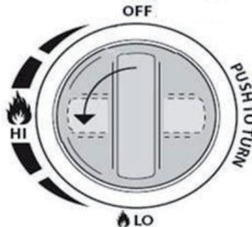
1. Überprüfen Sie, dass alle Drehknöpfe auf der Position „**OFF**“ stehen.
