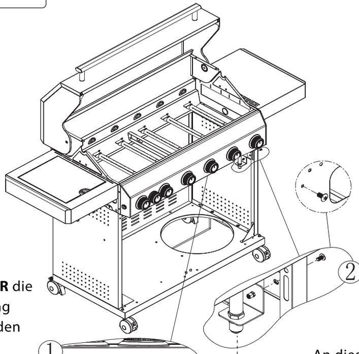
Durchtrennen Sie **NUR** die Kunststoff-Befestigung (Kabelbinder), **nicht** den Metall-Schlauch!
