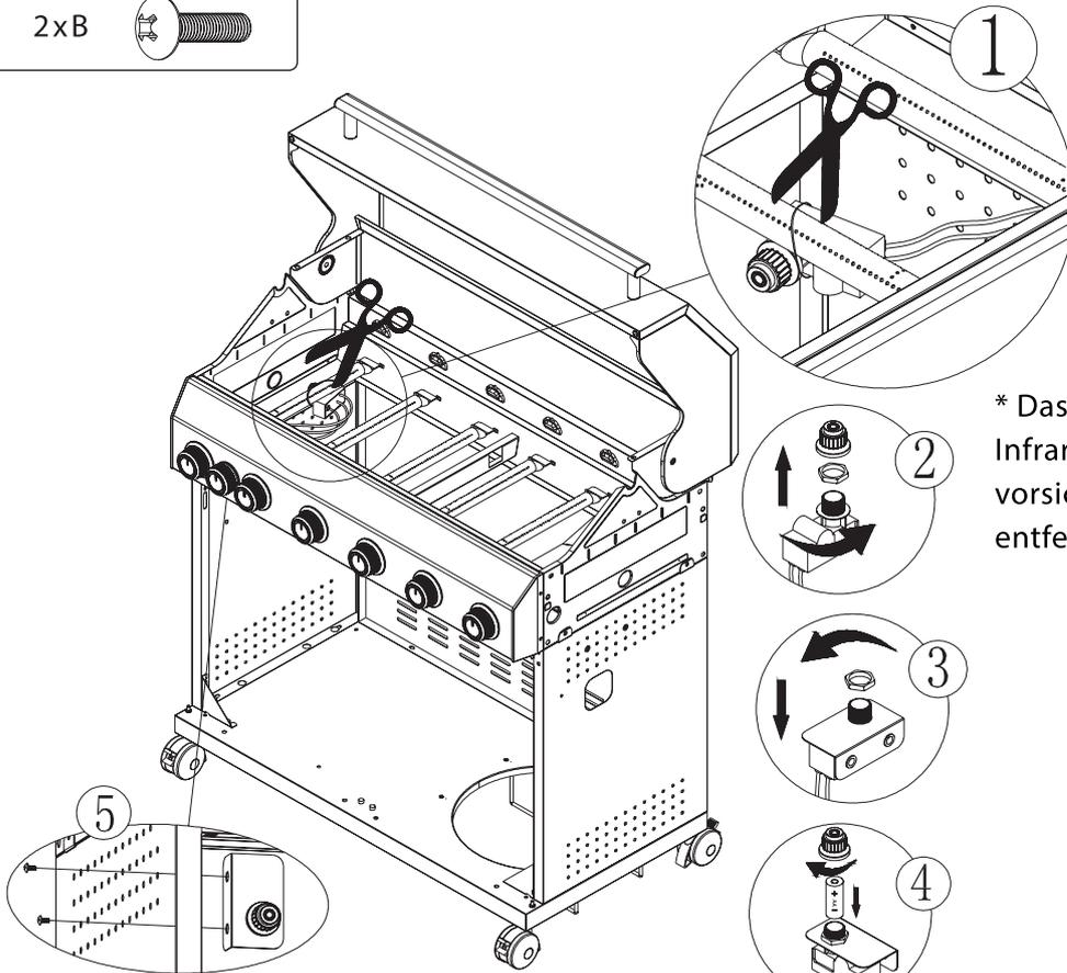
\* Das Batteriefach des Infrarot-Zündschalters vorsichtig vom Brenner entfernen.
