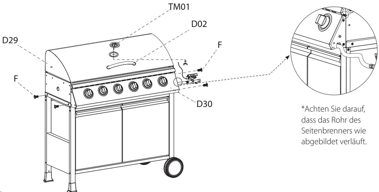
\*Achten Sie darauf, dass das Rohr des Seitenbrenners wie abgebildet verläuft.
