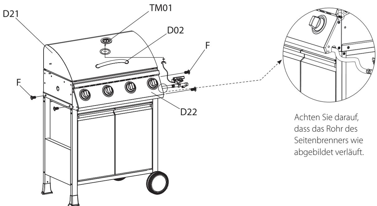
Achten Sie darauf, dass das Rohr des Seitenbrenners wie abgebildet verläuft.
