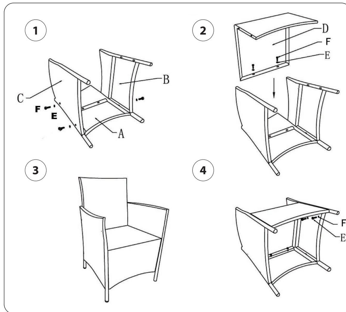
**Aufbau Tipp:** Drehen Sie zunächst alle Schrauben locker ein und ziehen Sie sie nach dem fertigen Aufbau fest. *All screws should be loose-fitted first, and then tight-fitted.*
