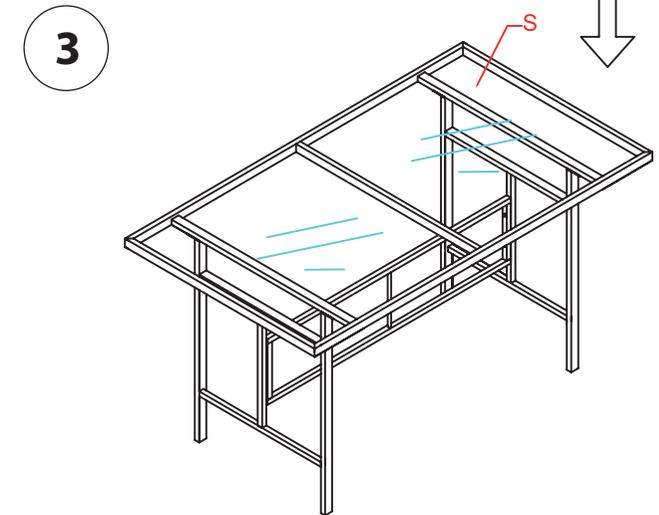
**Aufbau Tipp:** Drehen Sie zunächst alle Schrauben locker ein und ziehen Sie sie nach dem fertigen Aufbau fest.
