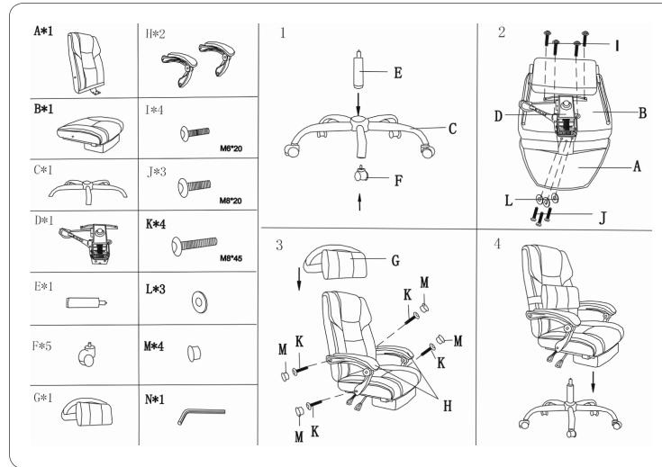
**Aufbau Tipp:** Drehen Sie zunächst alle Schrauben locker ein und ziehen Sie sie nach dem fertigen Aufbau fest.
