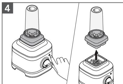
Drücken Sie zum Anhalten auf (▷|⊙). Entfernen Sie den mittelgroßen oder kleinen Behälter immer zusammen mit der Messereinheit von der Basis.
