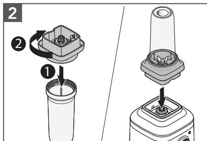
Befestigen Sie die Messereinheit an dem Behälter und drehen Sie sie im Uhrzeigersinn, bis sie fest sitzt. Bringen Sie den Behälter an der Basis an.
