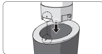
④ Befestigen Sie den Behälter, indem Sie ihn verkehrt herum aufstellen. Drehen Sie den Behälter nach unten, nachdem Sie die [I]-Schilder am Hauptgehäuse und an der Klingeneinheit ausgerichtet haben.
