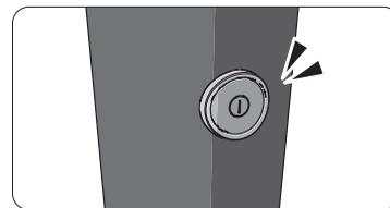
② Wenn das Mischen beendet ist, drücken Sie den Schalter erneut, bis ein Klickgeräusch zu hören ist. Das Gerät stoppt und wechselt in den [AUS]-Modus.
