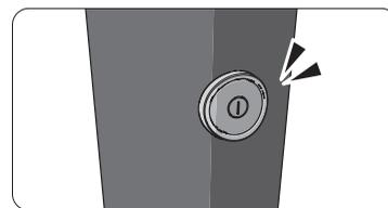
① Wenn beim Drücken des Netzschalters ein Klickgeräusch zu hören ist, beginnt der Vorgang mit dem Modus [EIN].
