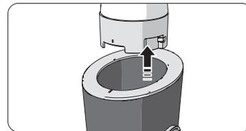
③ Entfernen Sie den Behälter, indem Sie ihn gegen den Uhrzeigersinn drehen.
